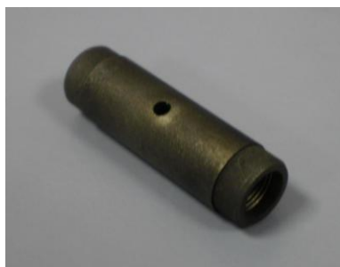
Obr. 7: Grafitová kyveta - ETA AAS. Zdroj: Agilent technologies Inc. (2013).
