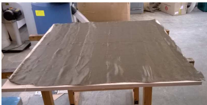
Obr. 14 Překližka s čedičovou tkaninou v přípravné fázi.
