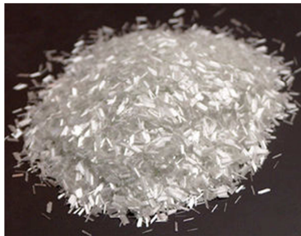
Obr. 7 Sekané skelné vlákno.
