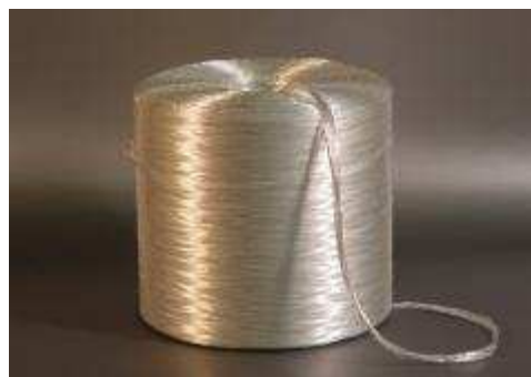
Obr. 8 Pramenec (roving) ze skelného vlákna.
