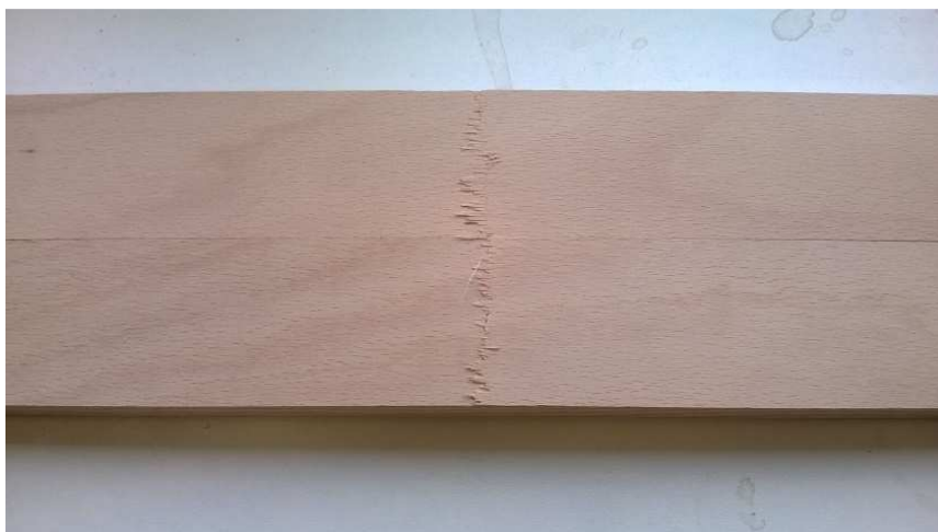
Obr. 28 Zkouška trojbodovým ohybem u překližky.
