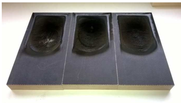
Obr. 35 Výsledek zkoušky stupně hořlavosti u kompozitního materiálu s čedičovým vláknem.
