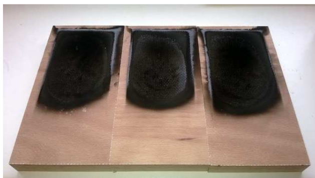
Obr. 33 Výsledek zkoušky stupně hořlavosti u kompozitního materiálu se skelným vláknem.
