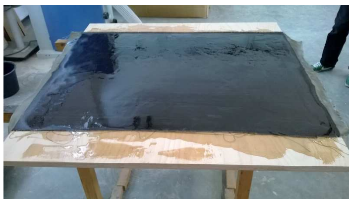
Obr. 15 Překližka po nanesení směsi epoxidové pryskyřice a s čedičovou vrstvou.
