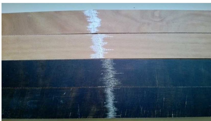
Obr. 25 Ukázka zlomu při zkoušce třibodovým ohybem u kompozitního materiálu s čedičovou vrstvou směrem dolů. V horní části je gramáž čediče 210 \text{ g/cm}^3 a v dolní části je gramáž 340 \text{ g/cm}^3 .
