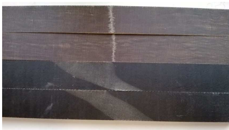
Obr. 25 Ukázka zlomu při zkoušce třibodovým ohybem u kompozitního materiálu s čedičovou vrstvou směrem dolů. V horní části je gramáž čediče 210 \text{ g/cm}^3 a v dolní části je gramáž 340 \text{ g/cm}^3 .
