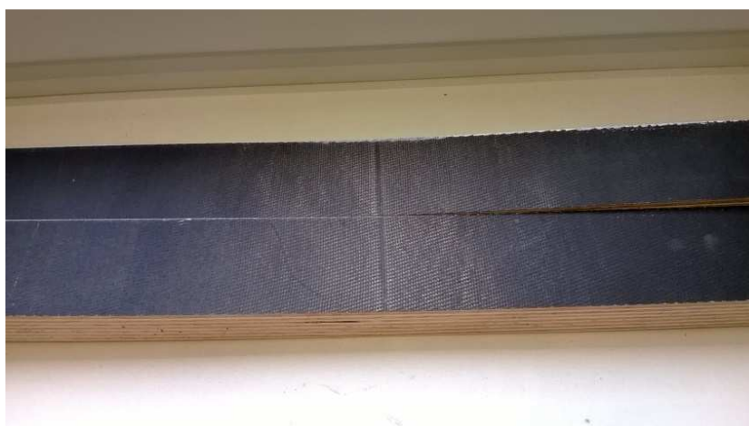
Obr. 27 Zkouška trojbodového ohybu u kompozitního materiálu s čedičovým vláknem směrem nahoru.
