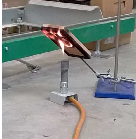
Obr. 21 Průběh zkoušky stanovení stupně hořlavosti.
