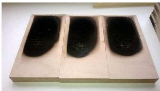
Obr. 34 Výsledek zkoušky stupně hořlavosti u překližky.
