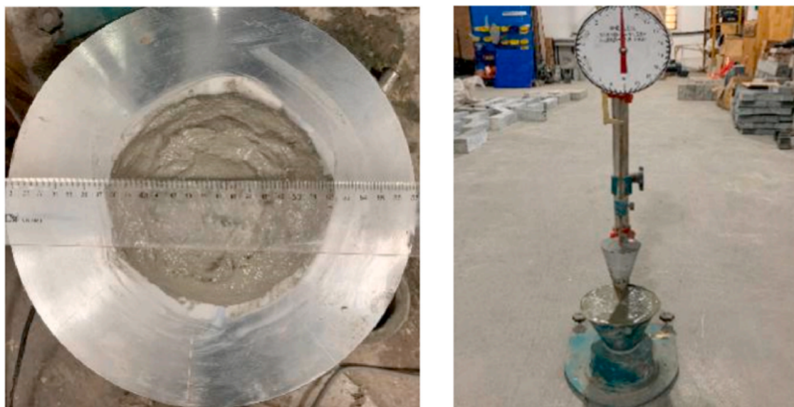
Obrázek 3.2: Střešací stolek a penetrace. Na obrázku vlevo je výsledek a zkouška na střešacím stole a vpravo je ukázka penetračního zařízení. [2]
