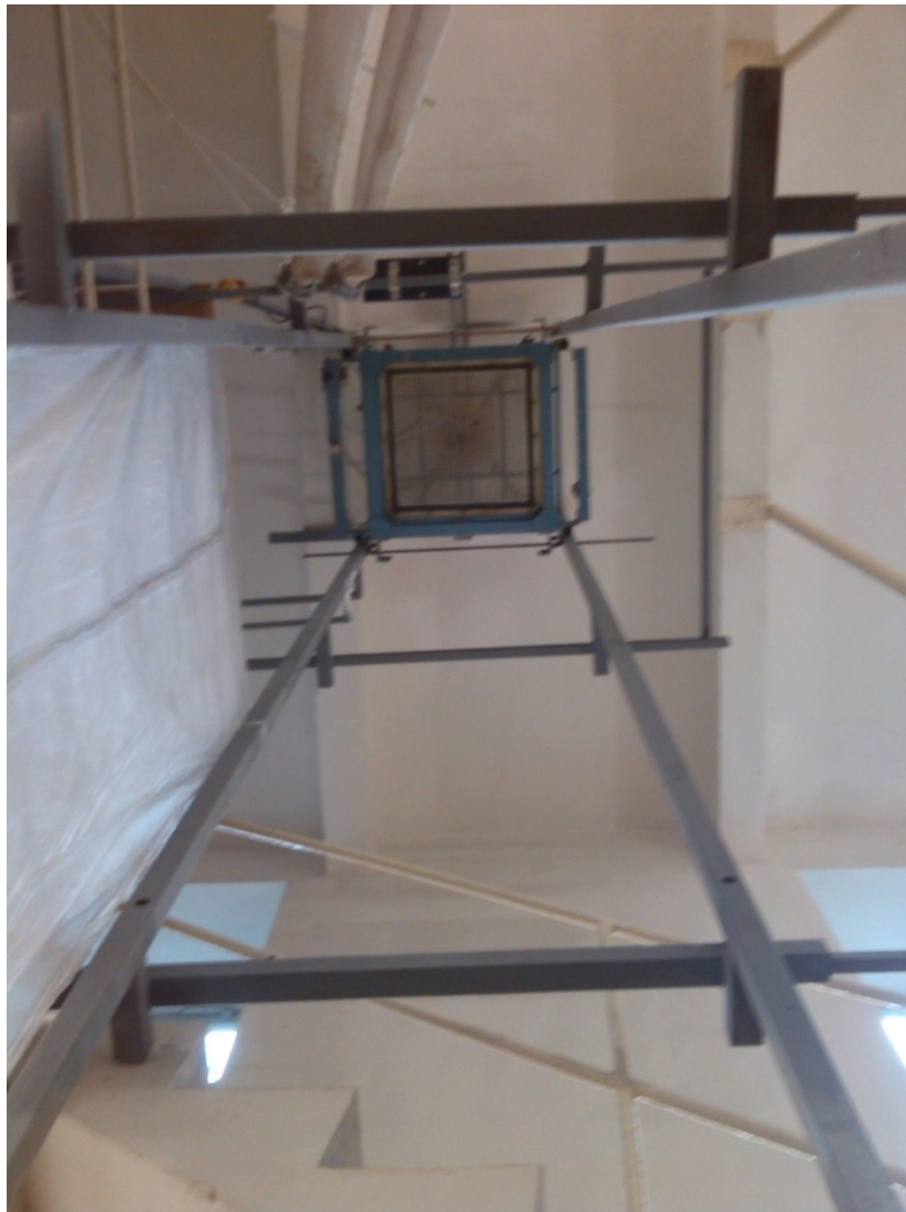
Obr. 7. Kapilární generátor kapek a pevná nosná konstrukce 19
