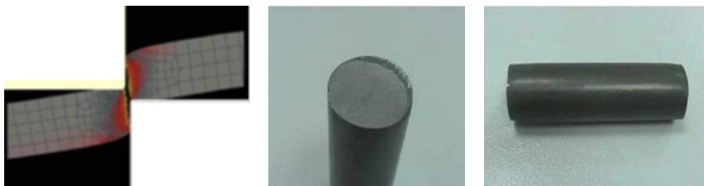
Obr. 12: Stříhání drátu + ukázka ústřížku [3]
