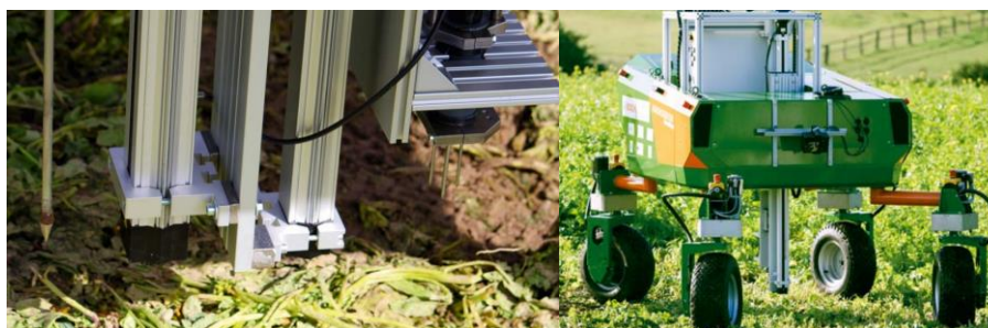
Obr. 27 Detail na měřicí modul (vlevo), BoniRob s modulem penetrometru (vpravo) [57]
