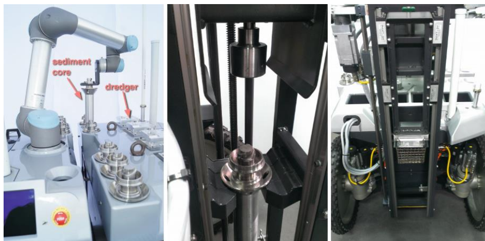
Obr. 23 Detail na robotické rameno (vlevo), sondovací trubku (uprostřed) a sběrný koš (vpravo)[46]
