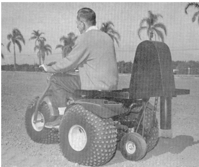
Obr. 17. Vzorkovací jednotka a úložná plošina namontované na zadní části terénní tříkolky [37]
