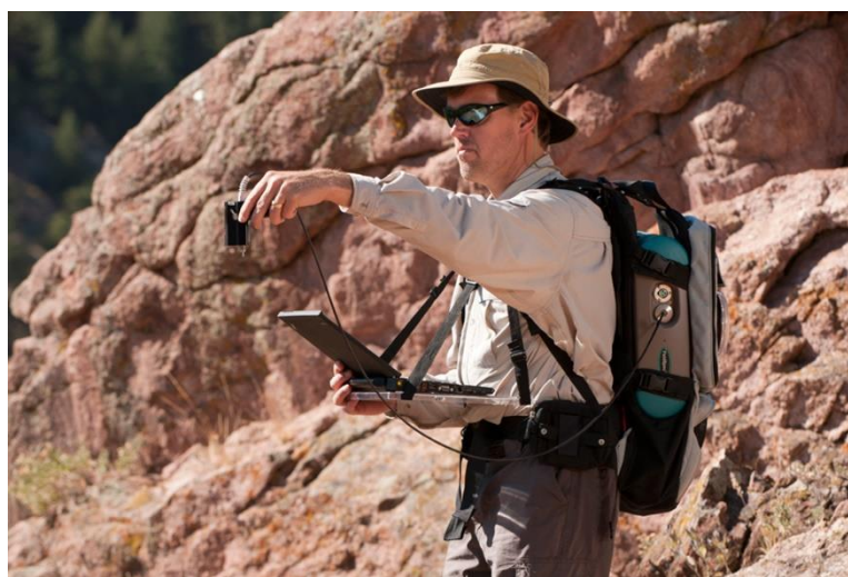
Obr. 5. ASD FieldSpec 4 Hi-Res – použití v terénu[9]
