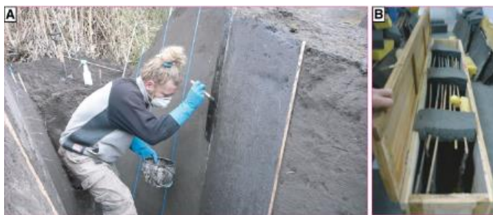
Obr. 7. A. Nanášení laku na povrch sondy B. Desky lak-filmu připravené v krabicích pro přepravu [24]
