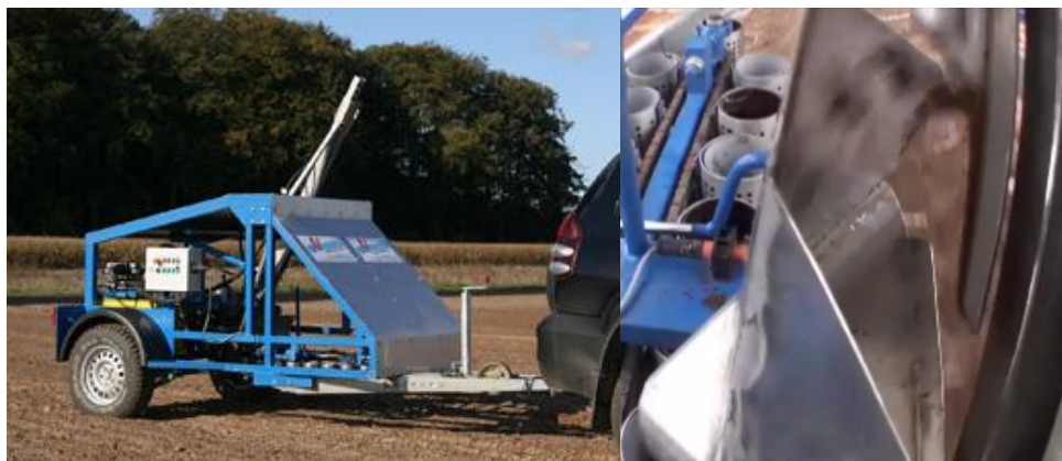
Obr. 16. Speedprob (vlevo) seškrábnutí vzorku půdy (vpravo) [36]
