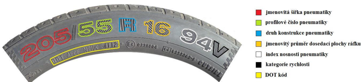
Obrázek 5: Základní značení pneumatiky [31]
