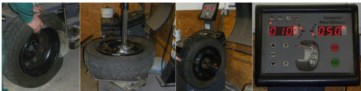
Obrázek 16: Přezouvání a vyvažování testovaných pneumatik [31]
