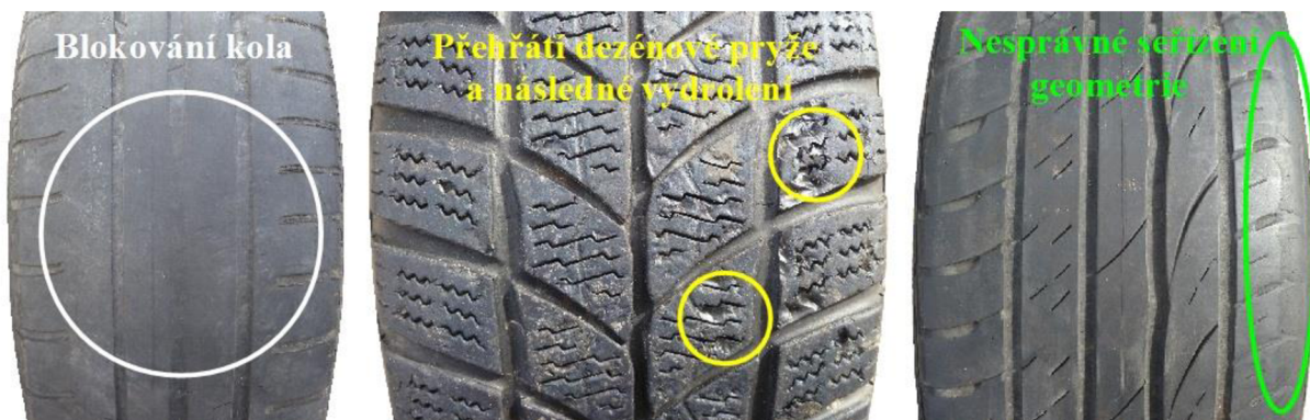
Obrázek 9: Příklady opotřebení pneumatik [31]
