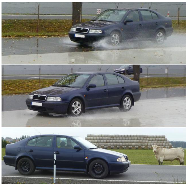
Obrázek 18: Měření brzdného zpomalení na letních pneumatikách [31]
