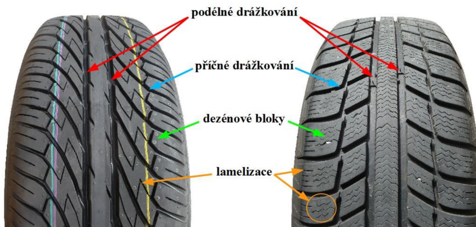
Obrázek 4: Srovnání dezénu letní a zimní pneumatiky [31]
