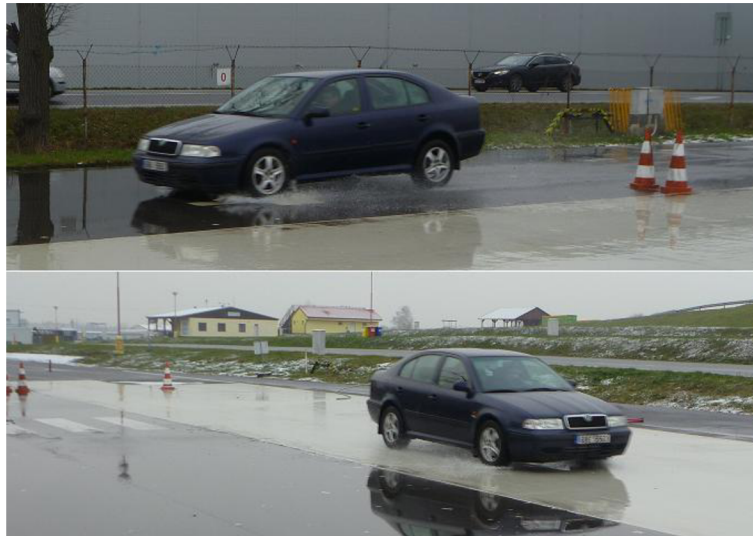
Obrázek 19: Měření brzdného zpomalení na zimních pneumatikách [31]
