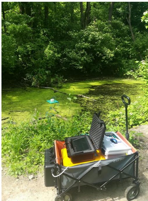
Obrázek 1: Měření difúzních emisí metanu z tůní pomocí přenosného analyzátoru plynů Los Gatos GGA-30p a připojené plovoucí komory Zdroj: R. Šmíd, 2022
