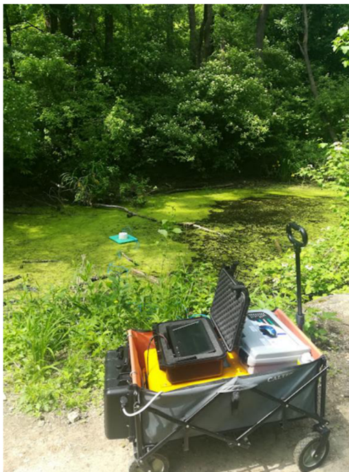
Obrázek 1: Měření difúzních emisí metanu z tůň pomocí přenosného analyzátoru plynů Los Gatos GGA-30p a připojené plovoucí komory Zdroj: R. Šmid, 2022
