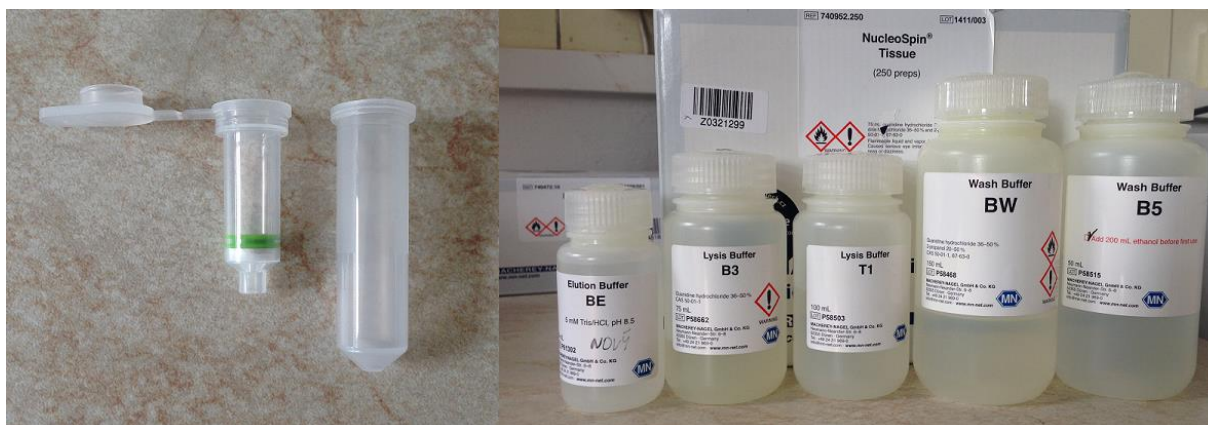
Obrázek 14 Mikrozumavka se silikátovým filtrem a použité pufrы
