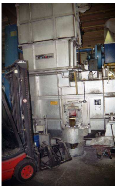
Obr. 10, Plynová šachtová tavící pec sklopná (odpichové)
