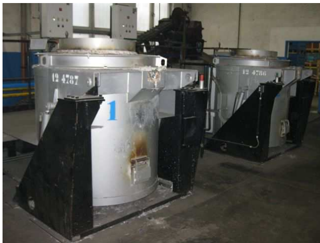
Obr. 9, Plynové sklopné tavící pece typu MORGAN [8]
