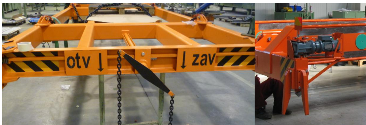
Obr. 7.6 Ovládní otočných zámků: a) ruční, b) elektrické [32]
