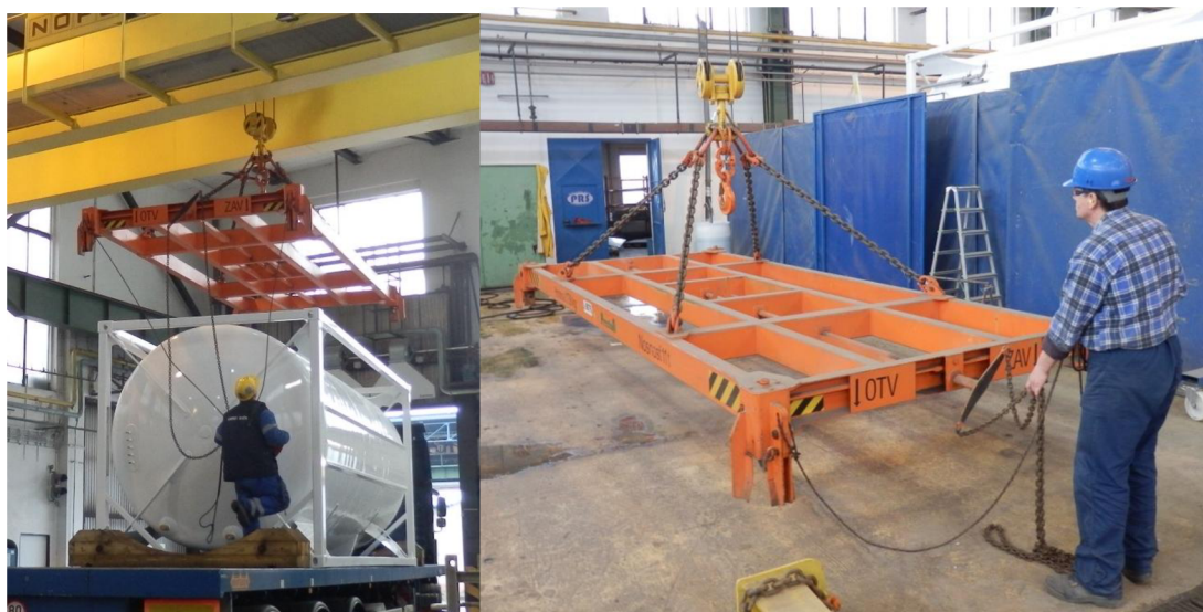
Obr. 7.2 Mechanické ovládání závěsného rámu [32]
