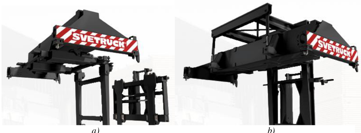
Obr. 6.7 Připojení k mobilnímu překladači a) nasunutím na vidlice, b) portálové [36]
