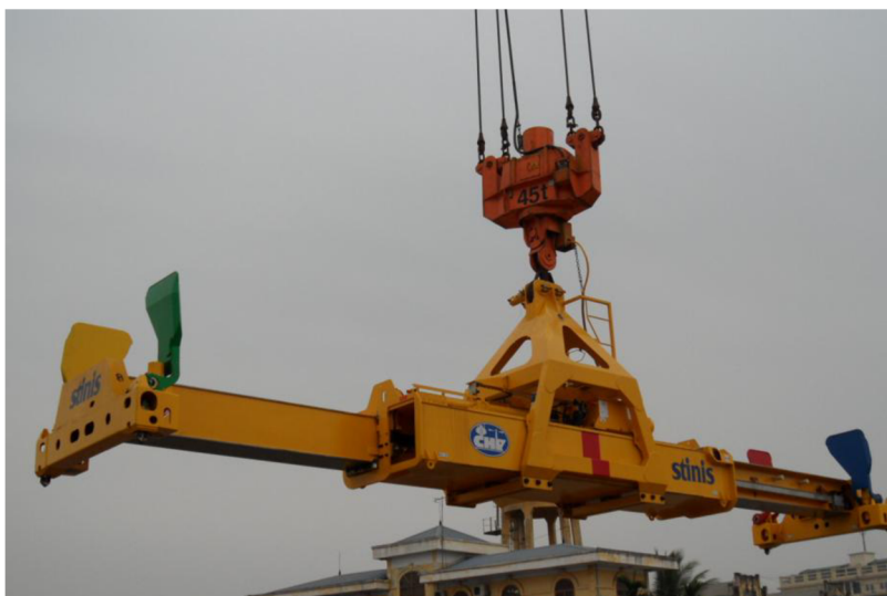
Obr. 6.4 Spojení závěsného rámu na hák jeřábu [35]
