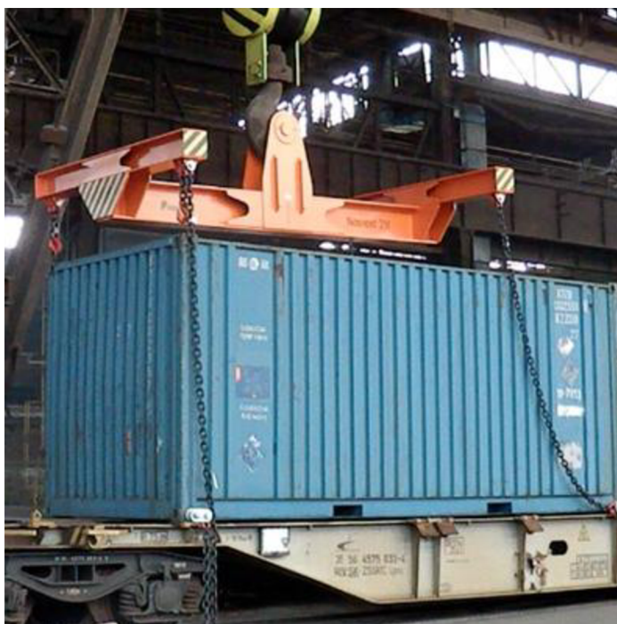
Obr. 7.20 Traverza s lanovými závěsy [31]
