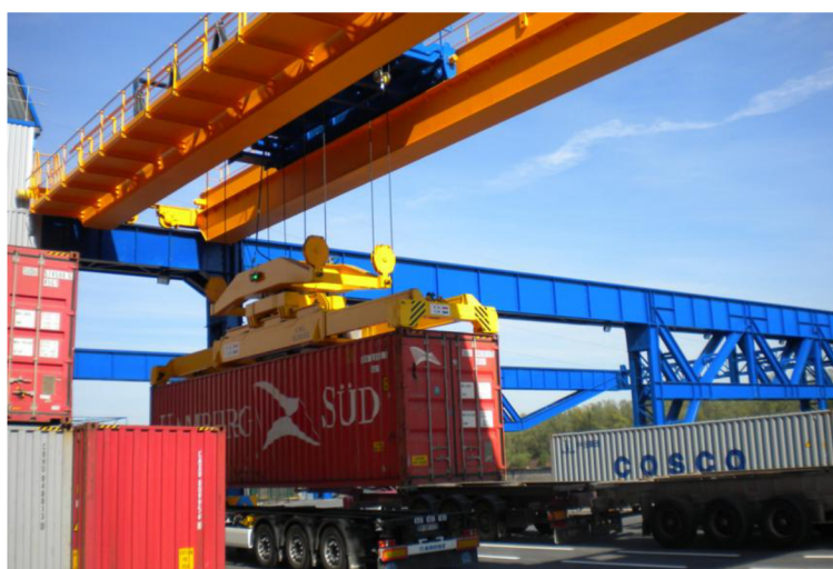
Obr. 8.7 Horní přestavitelný single lift závěsný rám [39]
