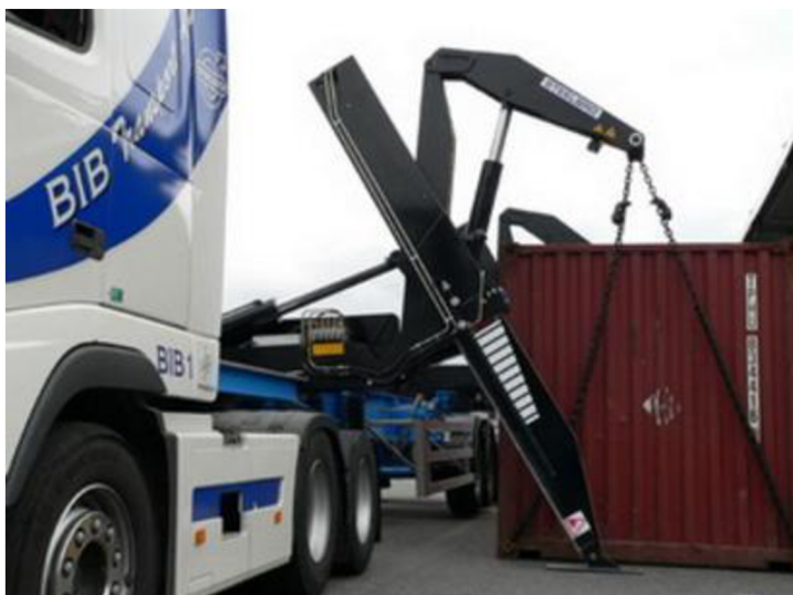
Obr. 6.8 Připojení lanových závěsů [24]
