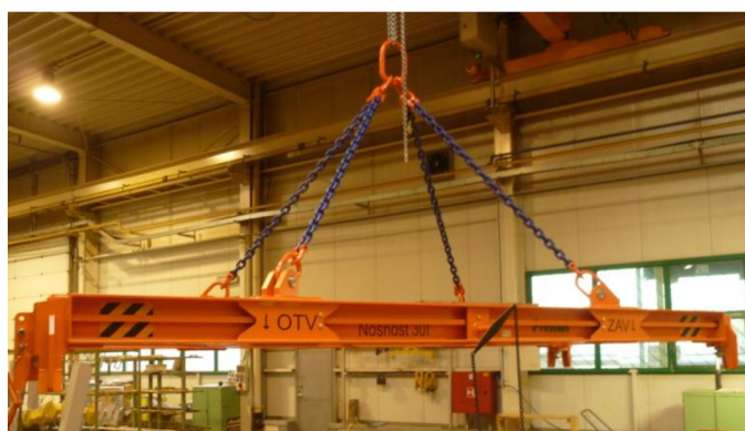
Obr. 6.5 Spojení jeřábu a závěsného rámu řetězy [32]
