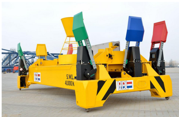
Obr. 7.8 Závěsný rám se sklopnými naváděcími lištami [39]
