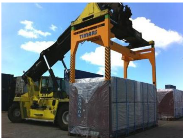
Obr. 8.2 Vyvýšený závěsný rám [38]
