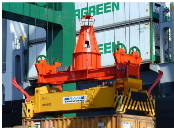
Obr. 6.3 Připojení závěsného rámu otočnými zámky [33]
