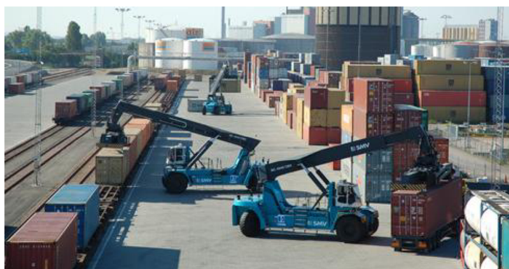
Obr. 5.7 Překládání kontejnerů mobilními překladači [29]
