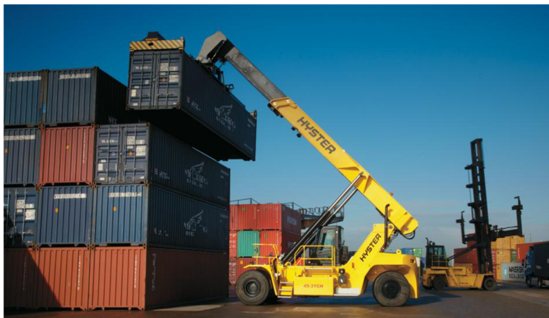
Obr. 8.8 Výsuvný stohovač s horním závěsným rámem [27]
