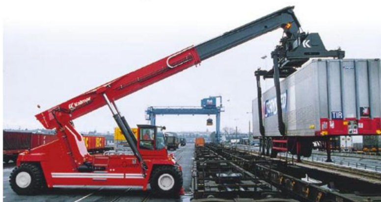
Obr. 8.9 Výsuvný stohovač se závěsným rámem s kleštinami [28]
