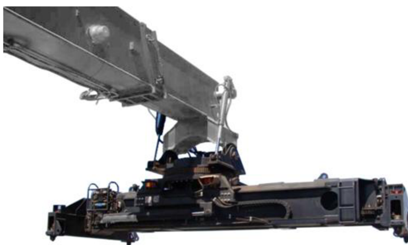
Obr. 7.10 Posuvný a naklápěcí závěsný rám [33]
