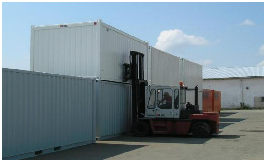
Obr. 7.18 Manipulace kontejnerů vidlicemi [21]
