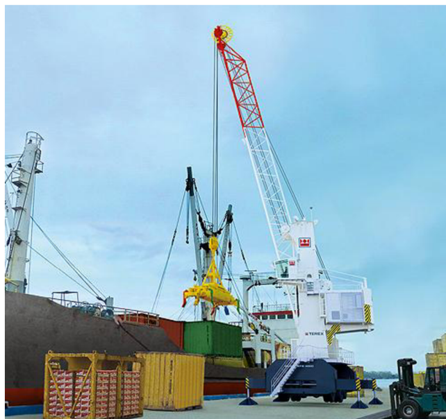
Obr. 5.6 Mobilní jeřáb na kolovém podvozku [37]
