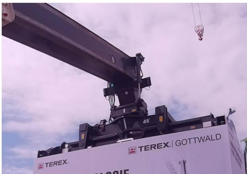
Obr. 6.6 Pevné připojení závěsného rámu k mobilnímu překladači [vlastní obrázek]
