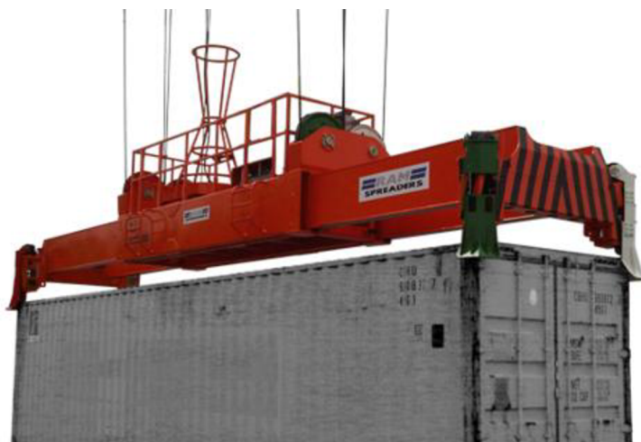
Obr. 6.1 Připojení závěsného rámu na kladnice [33]
