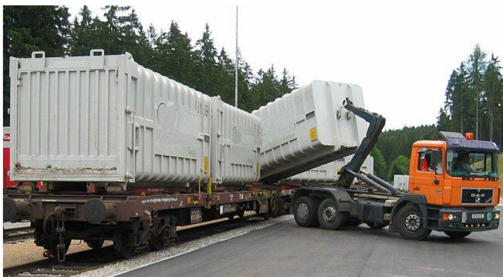
Obr. 2.2 Překládka odvalovacích kontejnerů [19]
