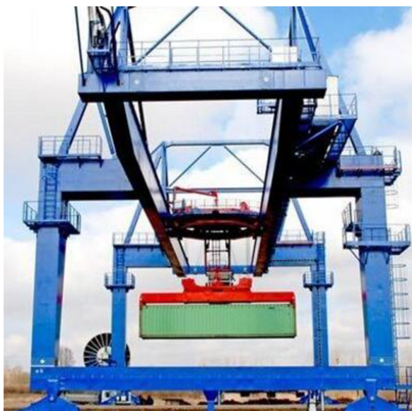
Obr. 8.6 Portálový jeřáb s horním přestavitelným závěsným rámem [22]
