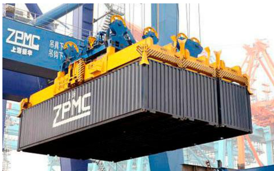
Obr. 7.14 Trojitý závěsný rám [40]
