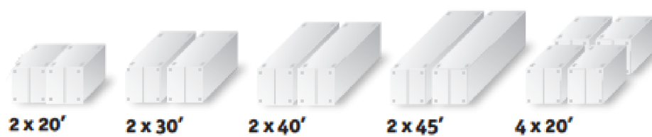
Obr. 7.13 Uchopovací kombinace dvojitého twin lift závěsného rámu [23]
