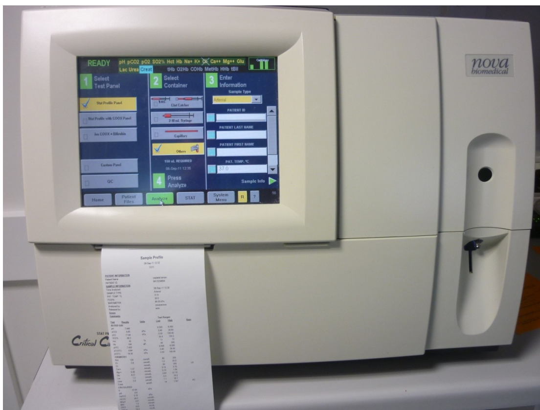
Obrázek 6. Kombinovaný acidobazický analyzátor Stat Profile CCX + COOX, Nova Biomedical, Waltham, USA.
