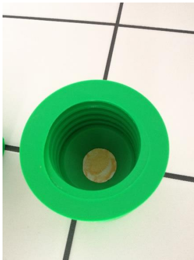
Obrázek č. 7: Vzorek připravený ve přetlakové sedimentační aparatuře.
