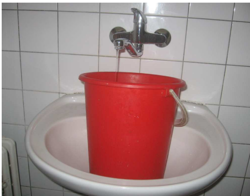
Obr. 4.13: Zachytávání měřené vody do nádob [17]
