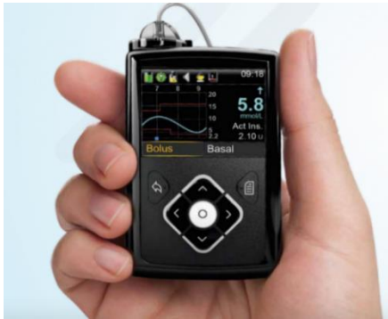
Obr. 4. Displej inzulínové pumpy se zobrazenými základními funkcemi CGM metody
