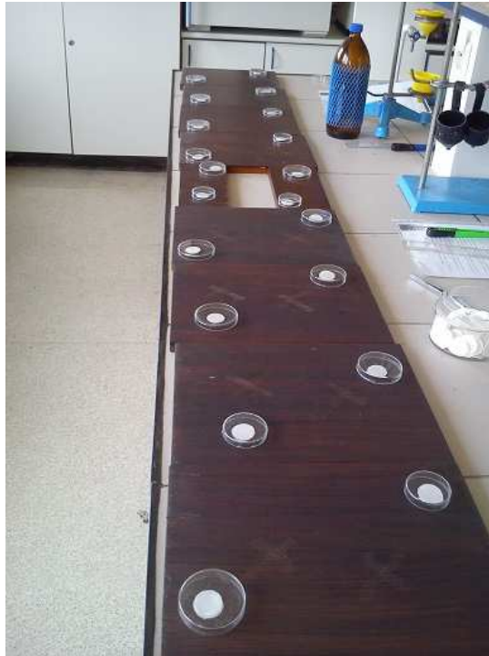
Obr. 6 Průběhu zkoušky na studené kapaliny (Lesák, vlastní foto 2015).
