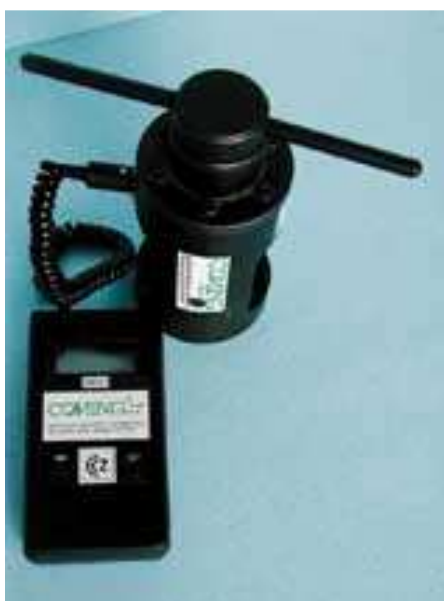
Obr. 5 Příklad přístroje na měření odtahové pevnosti ( http:// stavebnictvi3000.cz 2015).
