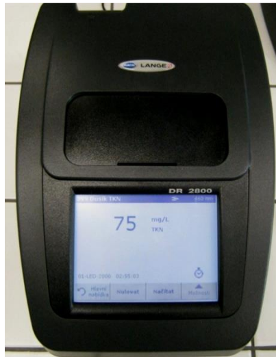
Obr. č. 14: Spektrofotometr Hach Lange DR 2800 (Foto: Dokulilová)
