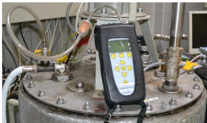
Obr. č. 5: Měření složení bioplynu pomocí přístroje COMBIMASS GA-m
