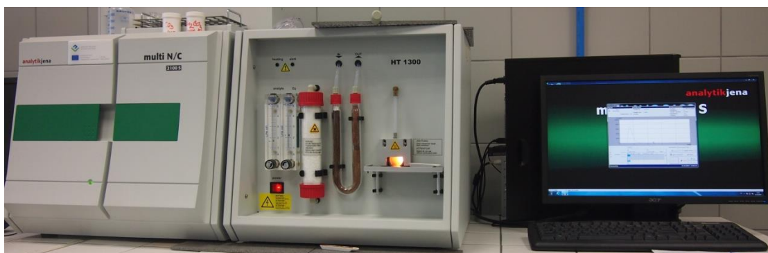
Obr. č. 11: Analyzátor multi N/C 2100S s pecí HT 1300 (Foto: Dokulilová)
