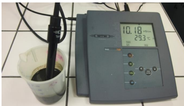
Obr. č. 6: Měření konduktivity laboratorním multimetrem WTW inoLab Multi 720 (Foto: Dokulilová)
