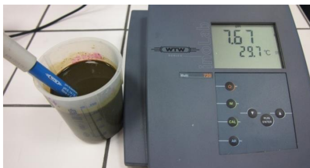
Obr. č. 8: Měření pH laboratorním multimetrem WTW inoLab Multi 720 (Foto: Dokulilová)
