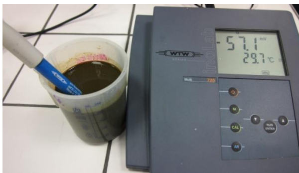
Obr. č. 7: Měření Eh laboratorním multimetrem WTW inoLab Multi 720 (Foto: Dokulilová)
