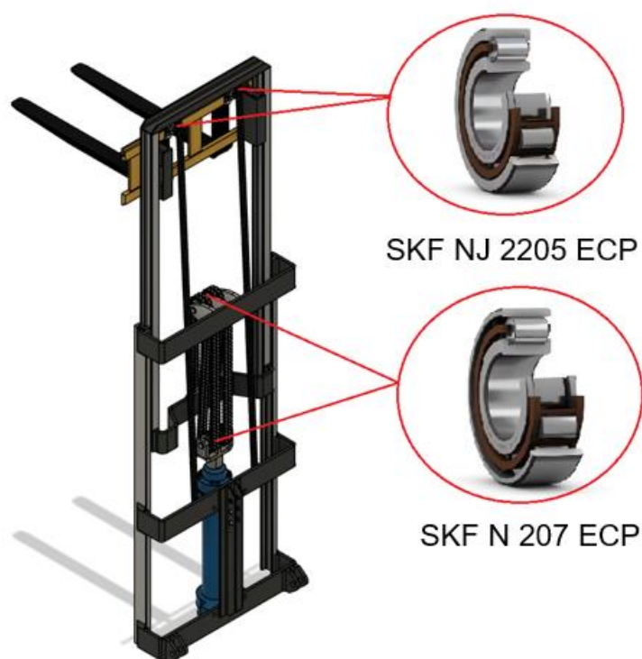
Obr. 14 – Znázornění ložisek v sestavě
