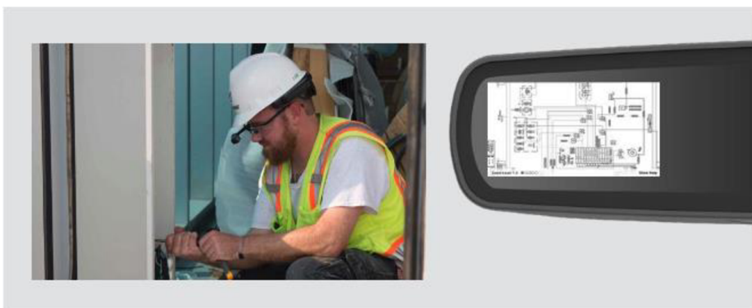
Obr. 11 Zobrazení ePlánů stroje na displeji chytrých brýlí
