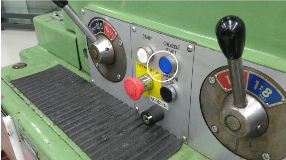
Zdroj: (vlastní; pořízeno chytrými brýlemi během testování) Obr. 9 Označení problematické části stroje zasahujícím technikem
