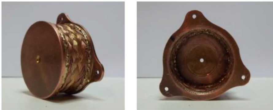
Obr. 2-2 Teplovodivá struktura CTB [3]
