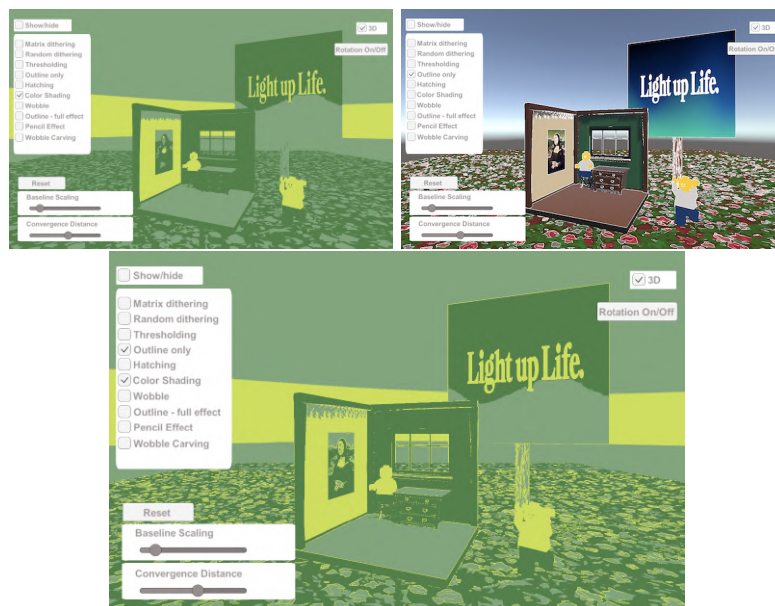
Obrázek 7.5: Kombinace barevného stínování a detekce hran pomocí Sobelova operátoru. V obrázku tak vznikají světle zelené obrysy objektů místo bílých při samotné detekci hran.
