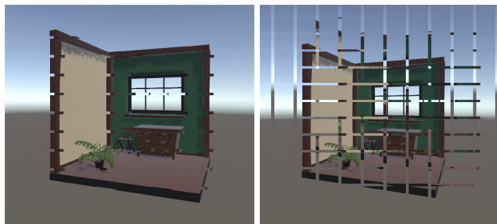
Obrázek 4.16: Použití periodického obdélníkového průběhu. Na levém obrázku je posun použit pouze ve směru osy x, na pravém obrázku je použit v obou směrech – vytváří se efekt čtverců.
