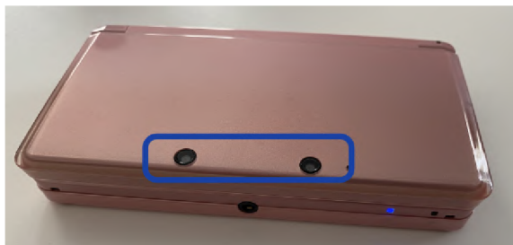
Obrázek 3.7: Dva zadní fotoaparáty konzole Nintendo 3DS. Pomocí dvou rozdílných obrazů a jejich následného spojení lze pořizovat fotografie ve 3D. Obrázek je z osobního archivu autora.
