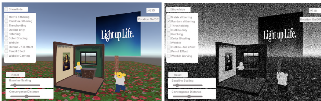
Obrázek 2.1: Výsledná aplikace implementovaná v nástroji Unity sloužící k testování. Testování slouží k zjištění, zda je možné efekty na stereoskopickém tabletu Lume Pad ve 3D režimu využívat ve srovnatelné kvalitě jako ve 2D režimu. Pravý obrázek zobrazuje efekt náhodného rozptýlení, který je jedním z implementovaných a popsanych efektů v této práci.
