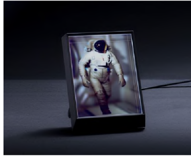
Obrázek 3.4: Looking Glass Portrait je nejmenším z nabízených displejů. Obrázek je převzatý z oficiální webové stránky Looking Glass Factory 3 .
