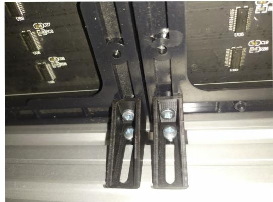
Obr. 3.9: Ukázka držáku a uchycení displeje.
