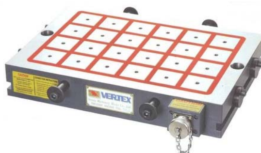
Obr. 1.16 Elektropermanentní mag. deska [18].
