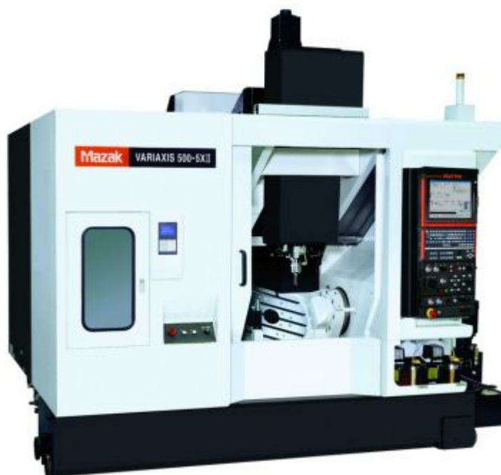
Obr. 1.5 Pětiosé svislé obráběcí centrum [7].
