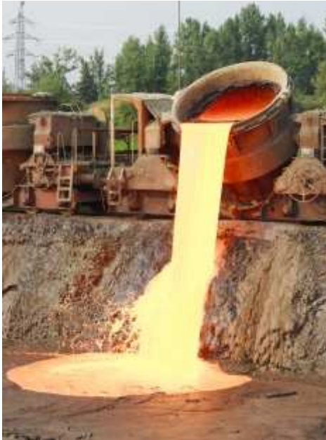
Obr. 6.1: Vyprazdňování žhavé strusky [25]
