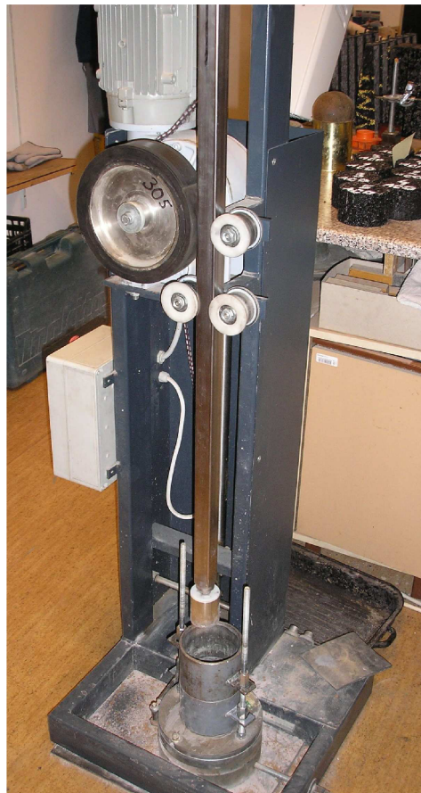
Obr. 8.1: Zařízení Proctor Standard
