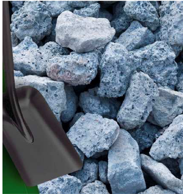
Obr. 6.2: Struskové kamenivo, frakce 63 – 125 mm [25]
