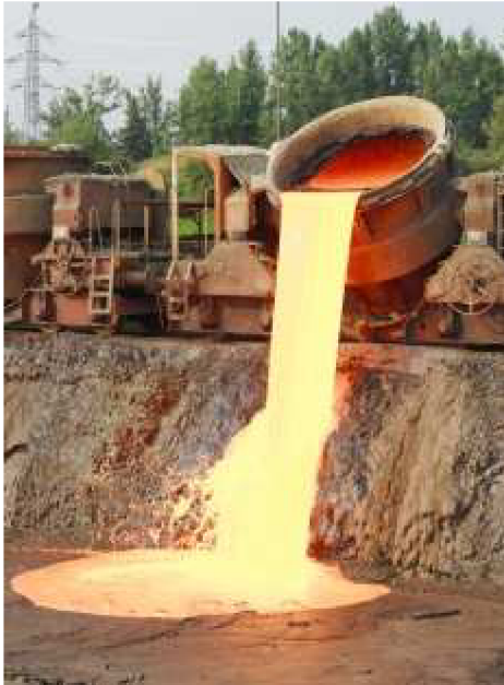
Obr. 6.1: Vyprazdňování žhavé strusky [25]
