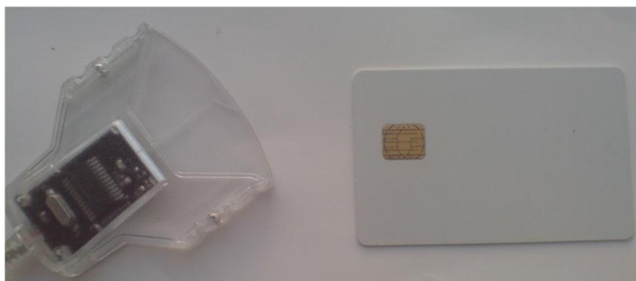
Obrázek 4: Čtečka smart karet (vlevo) a karta Gemalto .NET Smart Card V2+ (vpravo).
