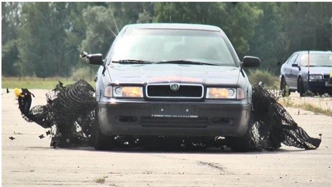
Obr. č. 11 - Ukázka použití zastavovací sítě X-NET 58
