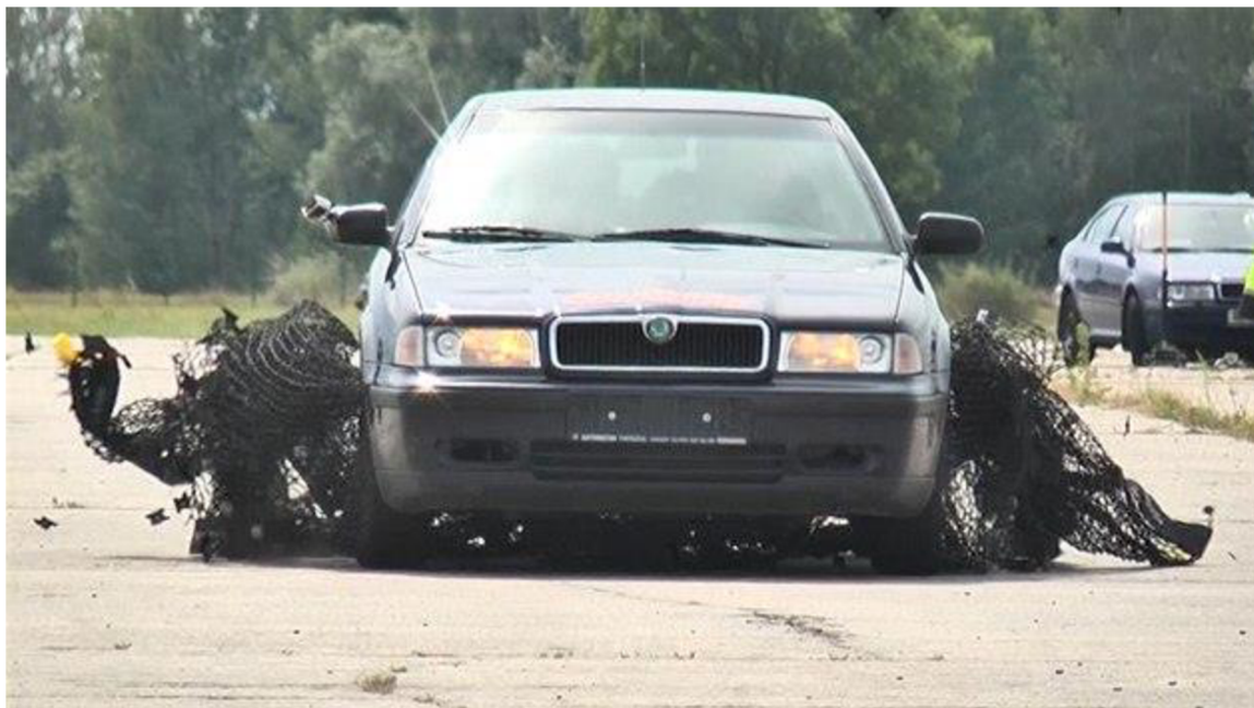
Obr. č. 11 - Ukázka použití zastavovací sítě X-NET 58
