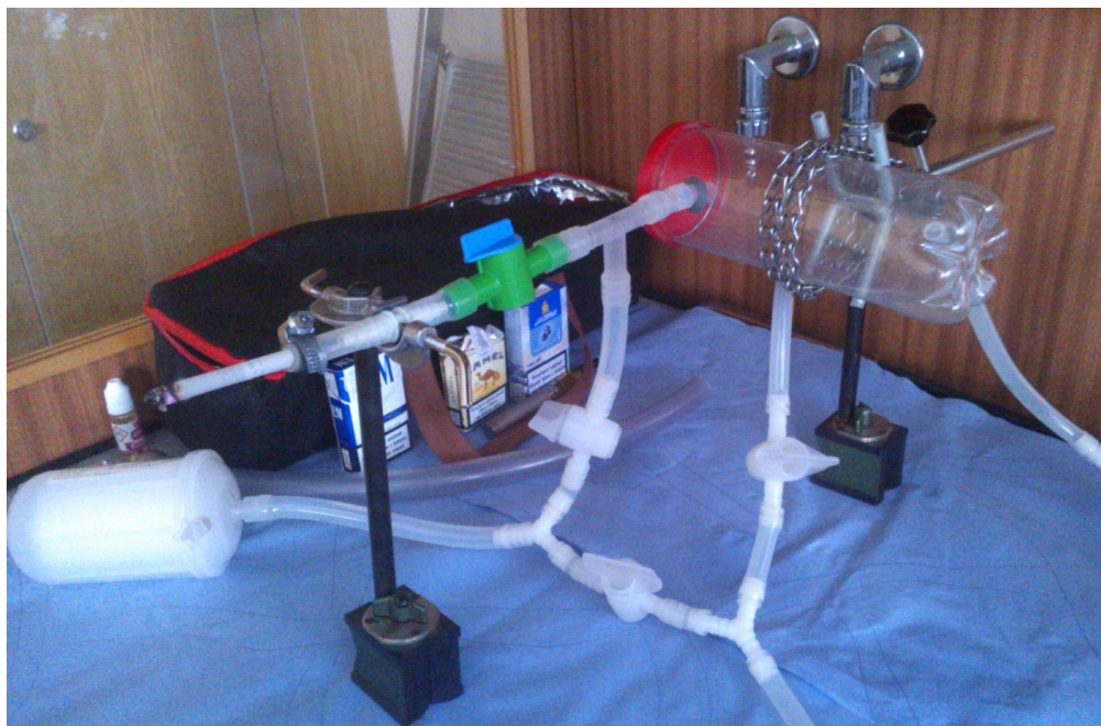
Obr. 24 – Fotka zapojení měřicího okruhu s cigaretou.
