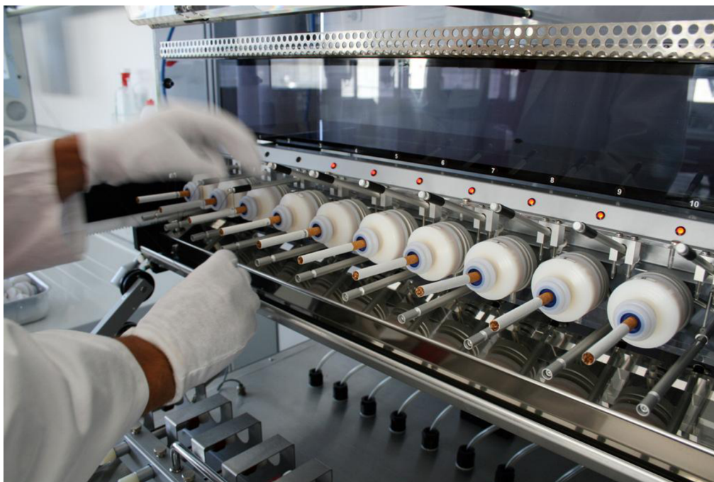
Obr. 18 – Zařízení na testování tabákových výrobků CERULEAN SM410 (Itálie).
