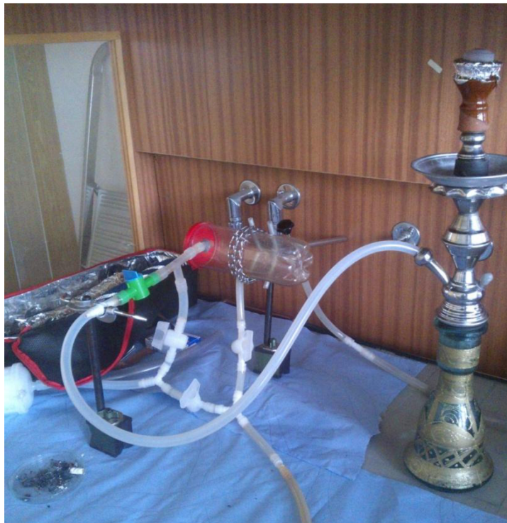
Obr. 34 – Zapojení měřicí tratě s vodní dýmku.
