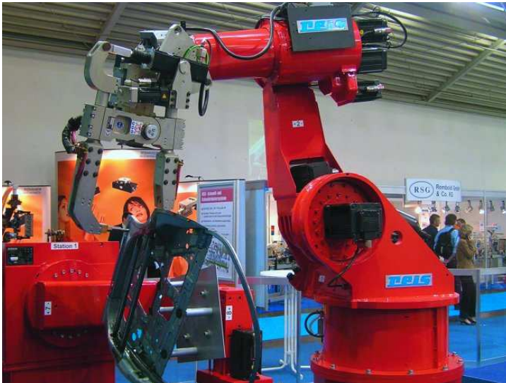
Obr. 19 Robotizované pracoviště s bodovým svařováním [8]
