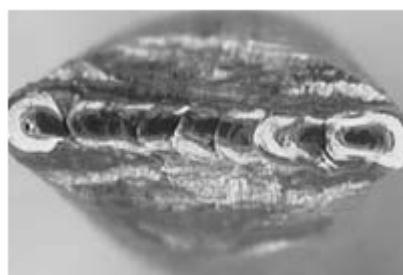
Obr. 4 Plzní svar v ochranné atmosféře He [4] Obr. 5 Plzní svar v ochranné atmosféře Ar [4]
