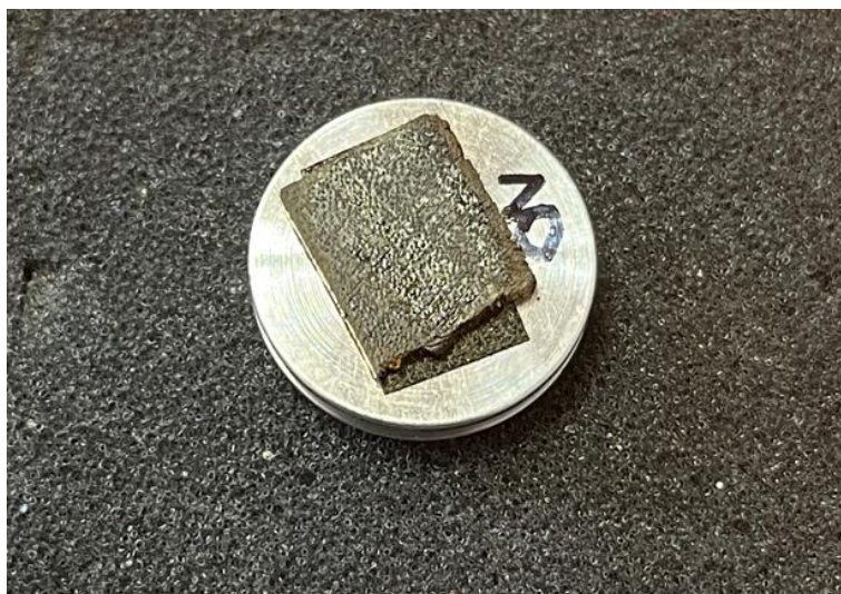
Obrázek 48 - Příčný řez Ipe s vyroněnou pryskyřicí
