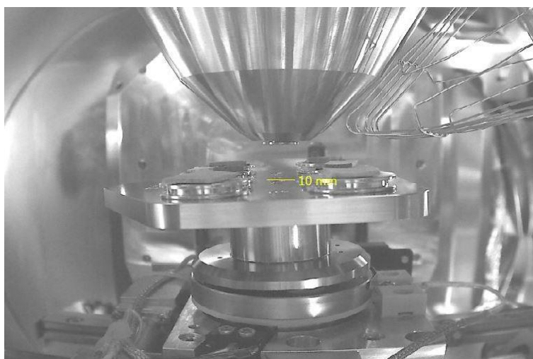
Obrázek 39 - Umístění vzorků v komoře SEM
