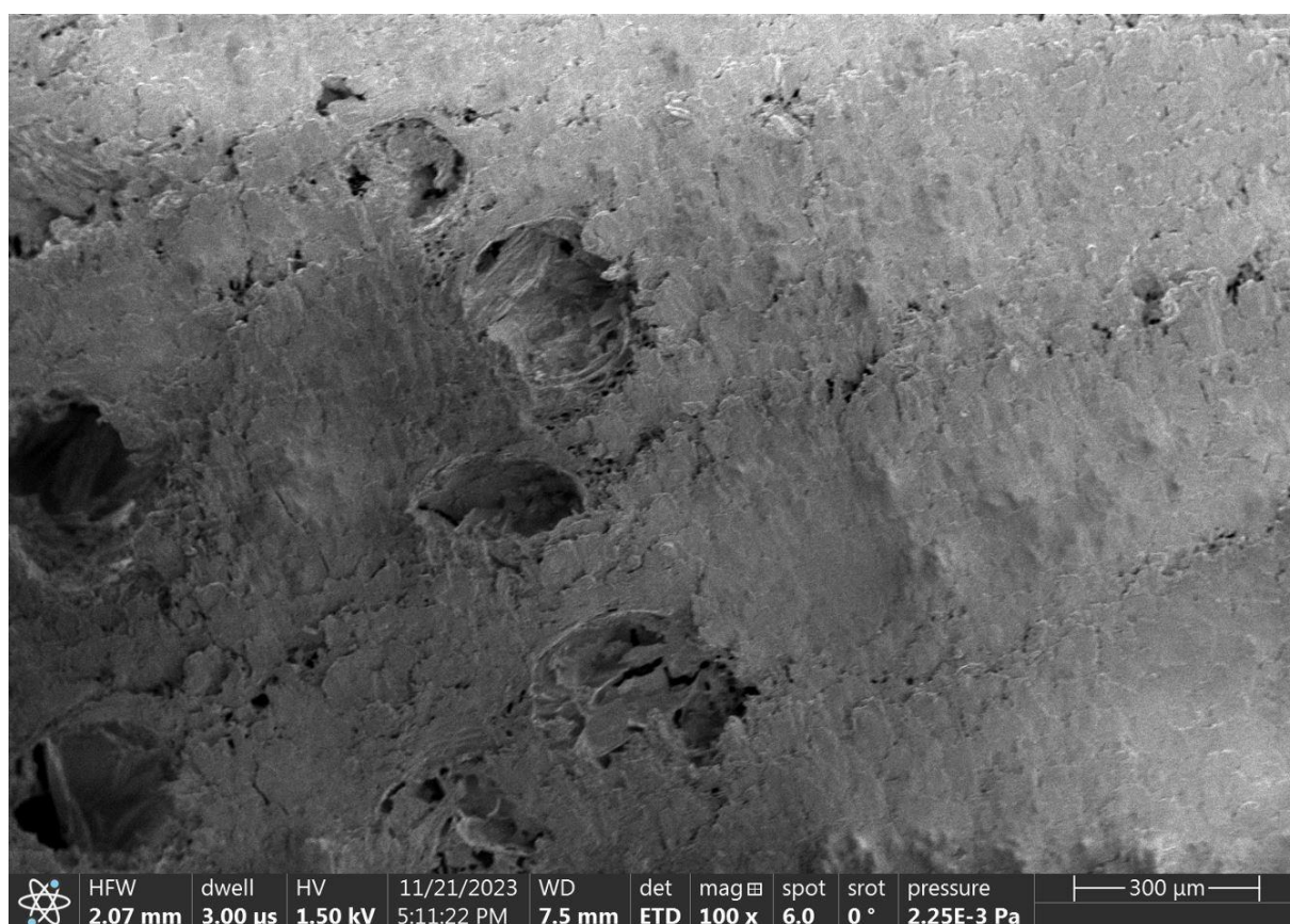
Obrázek 20 - Vzhled povrchu dubu po použití kotoučové pily
