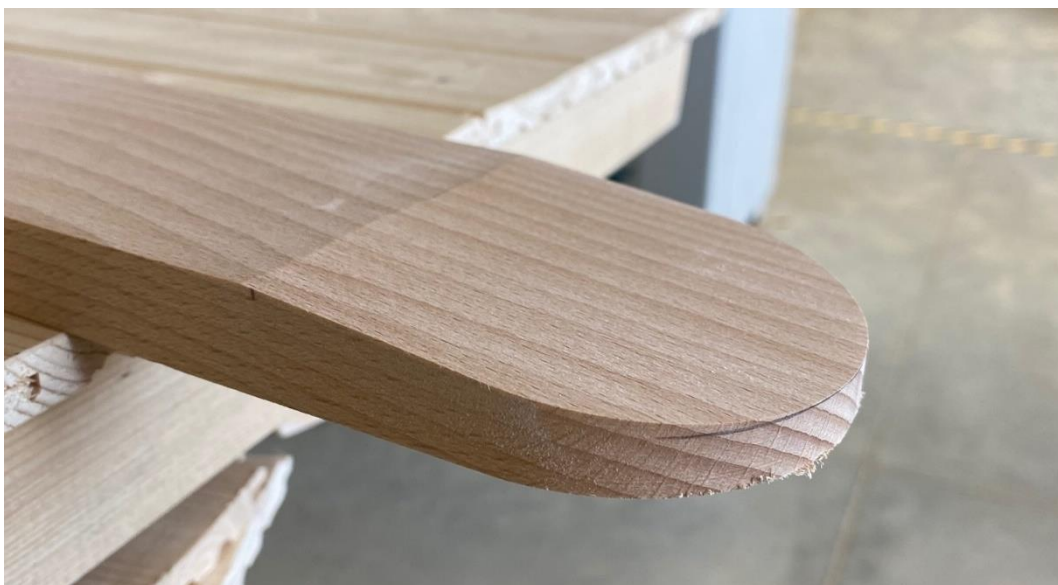
Obrázek 70 - Zkosená hrana dílce pro spodní kříž
