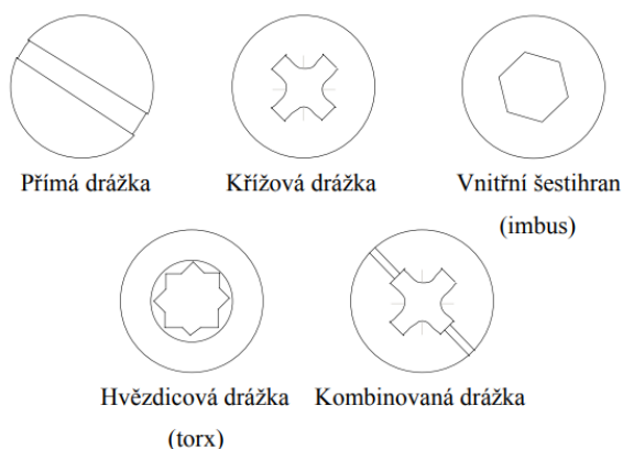
Obrázek 14 - Typy drážek vrutů a šroubů (upraveno dle Muzikáře, 2008)
