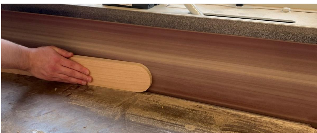
Obrázek 69 - Zkosení hran dílců pro spodní kříž
