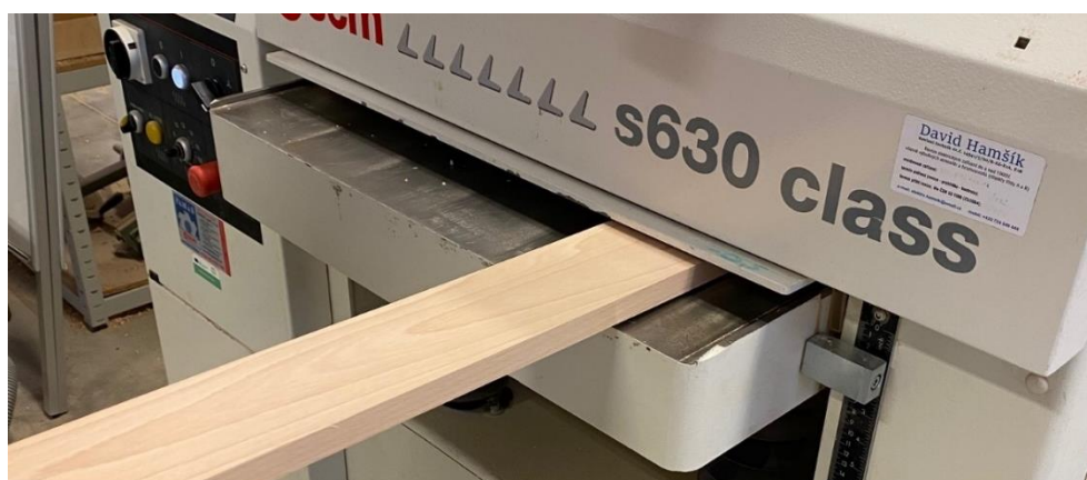
Obrázek 75 - Tloušťková egalizace prken na výrobu duté nohy
