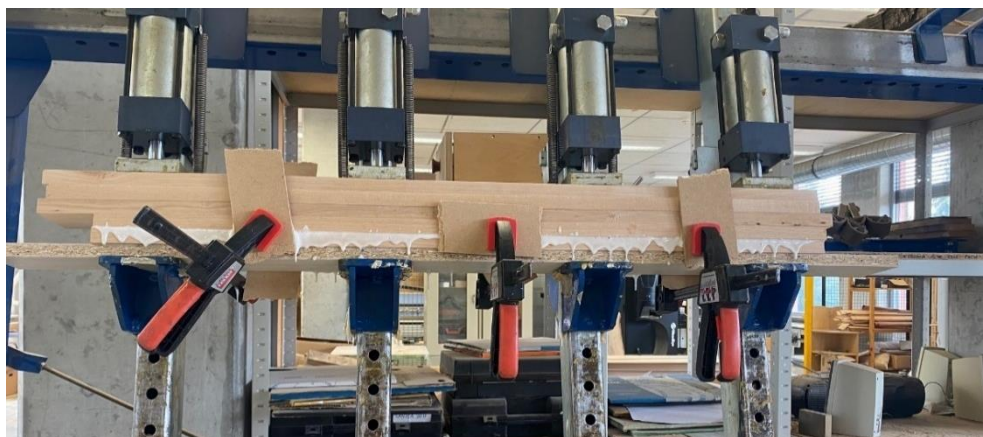
Obrázek 65 - Vytvrzení slepených dílců v lisu
