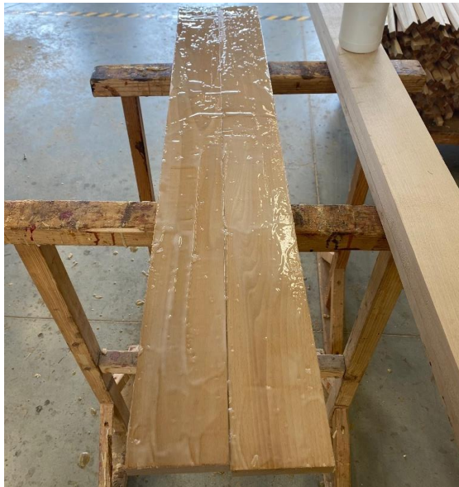
Obrázek 64 - Nanášení lepidla na masivní dílce
