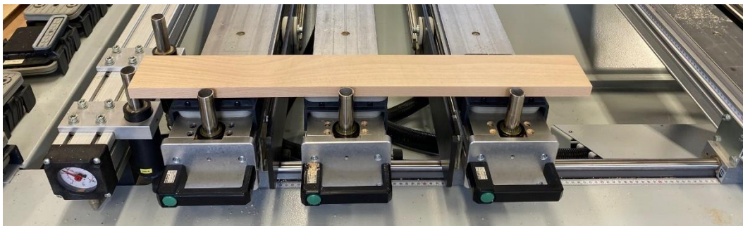
Obrázek 67 - Upnutí dílců na CNC
