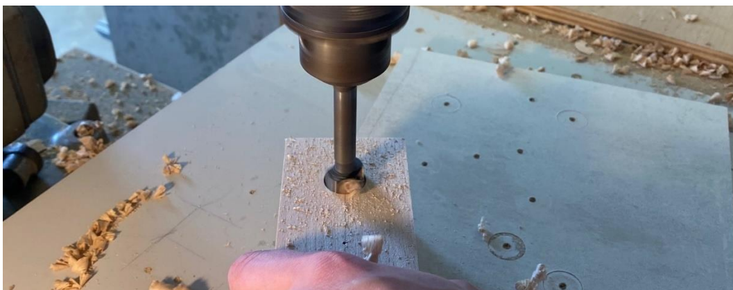
Obrázek 76 - Vyvrtání otvorů pro kolíky k výškovému nastavení židle
