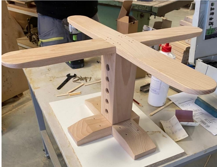
Obrázek 86 - Sestavení židle pro spojení pomocí vrutů
