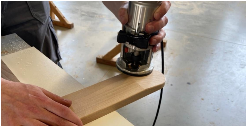
Obrázek 84 - Zaoblení hran ruční horní frézou
