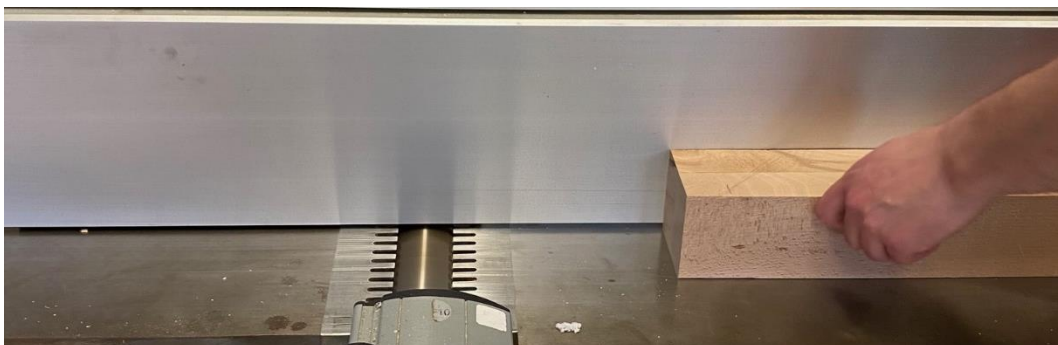
Obrázek 72 - Srovnání hran dílců pro horní kříž
