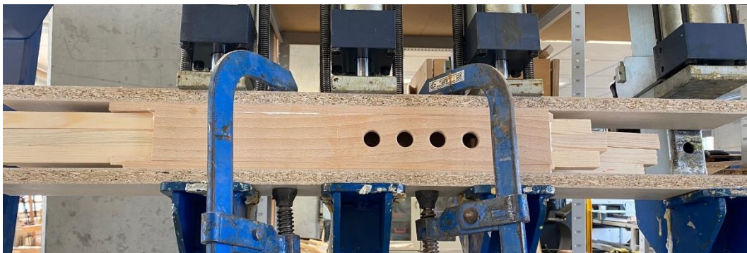
Obrázek 78 - Slepění duté nohy na rámovém lisu
