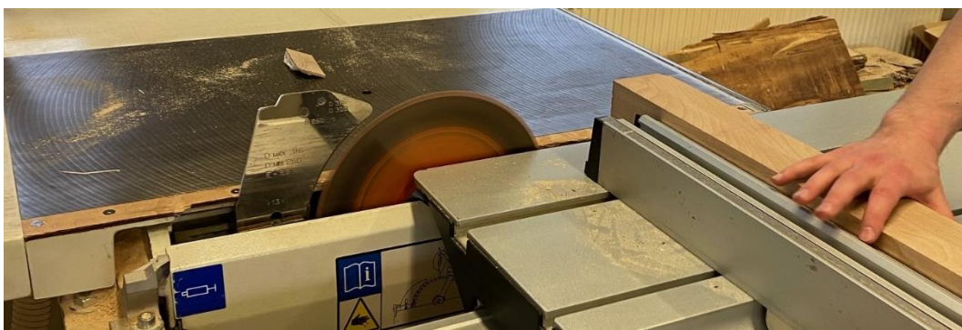
Obrázek 79 - Nařezání hranolu na hrubou délku 400 mm
