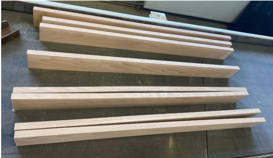
Obrázek 63 - Zkrácený bukový masiv na hrubý rozměr
