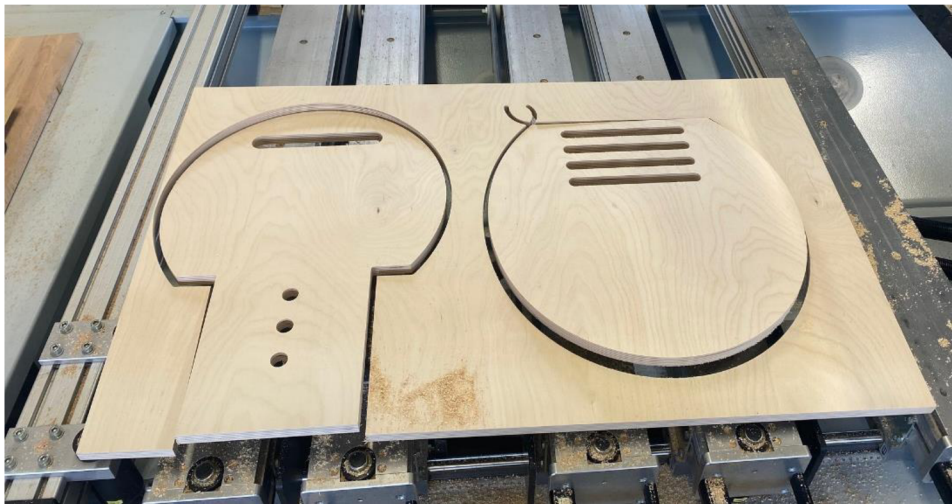
Obrázek 61 - Výroba sedáku a opěradla na CNC
