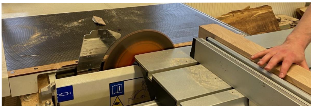
Obrázek 79 - Nařezání hranolu na hrubou délku 400 mm
