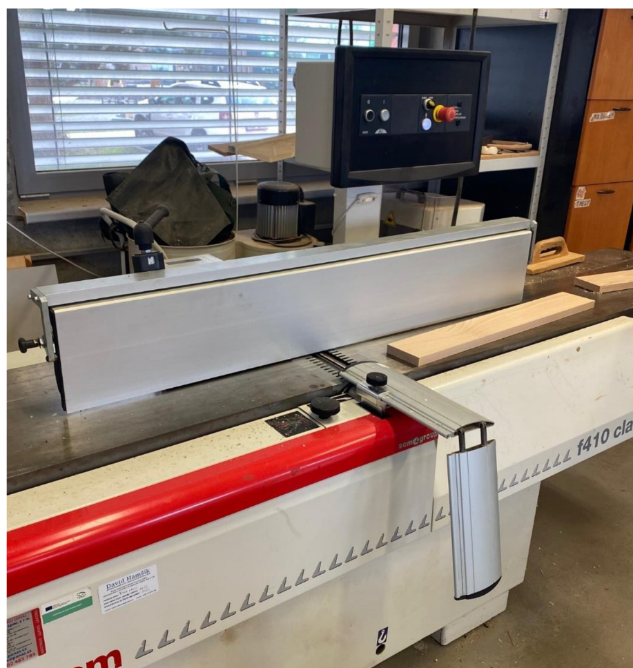
Obrázek 66 - Srovnání dílců do pravého úhlu na spodní frézce
