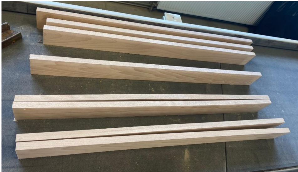
Obrázek 63 - Zkrácený bukový masiv na hrubý rozměr
