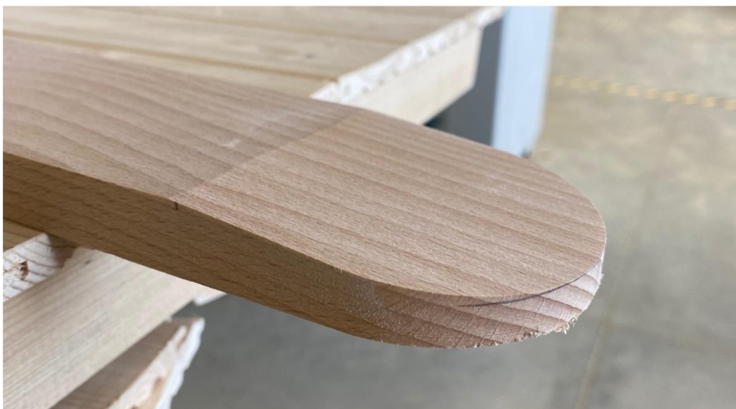
Obrázek 70 - Zkosená hrana dílce pro spodní kříž
