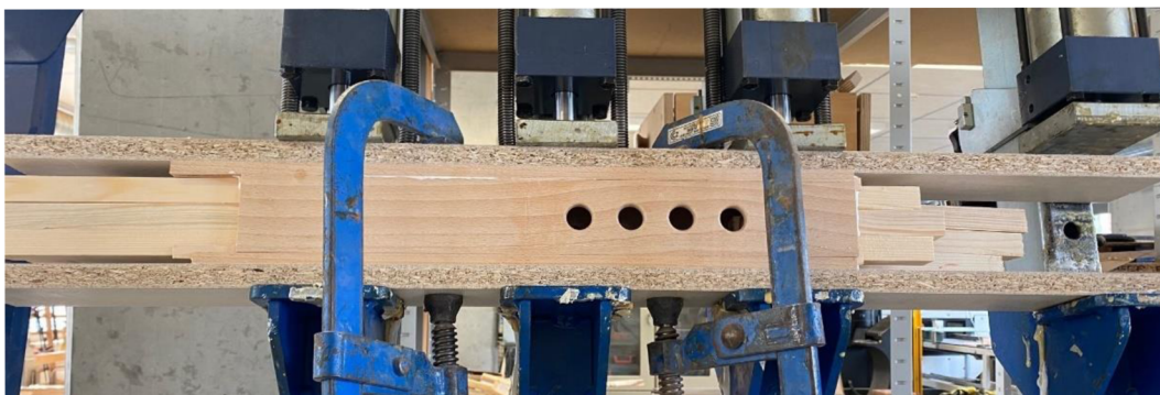
Obrázek 78 - Slepění duté nohy na rámovém lisu
