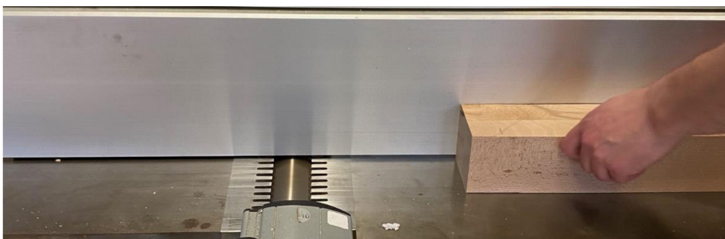
Obrázek 72 - Srovnání hran dílců pro horní kříž
