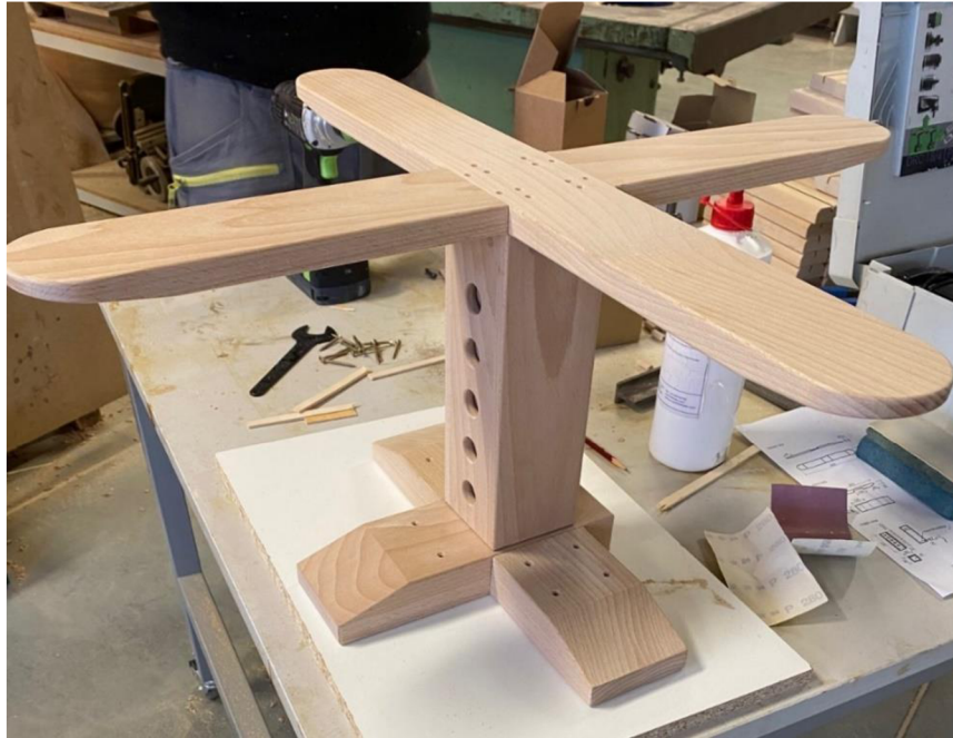
Obrázek 86 - Sestavení židle pro spojení pomocí vrutů
