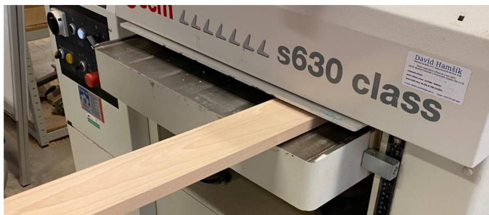
Obrázek 75 - Tloušťková egalizace prken na výrobu duté nohy
