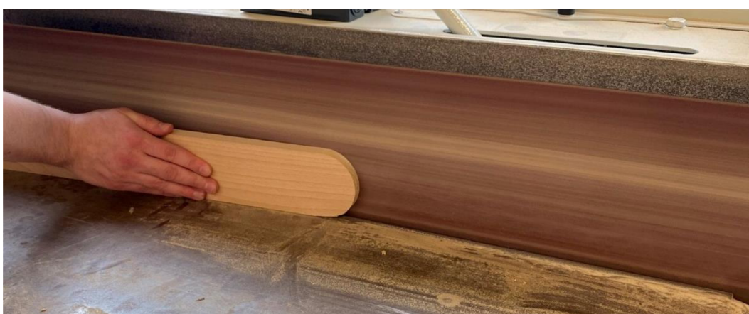
Obrázek 69 - Zkosení hran dílců pro spodní kříž
