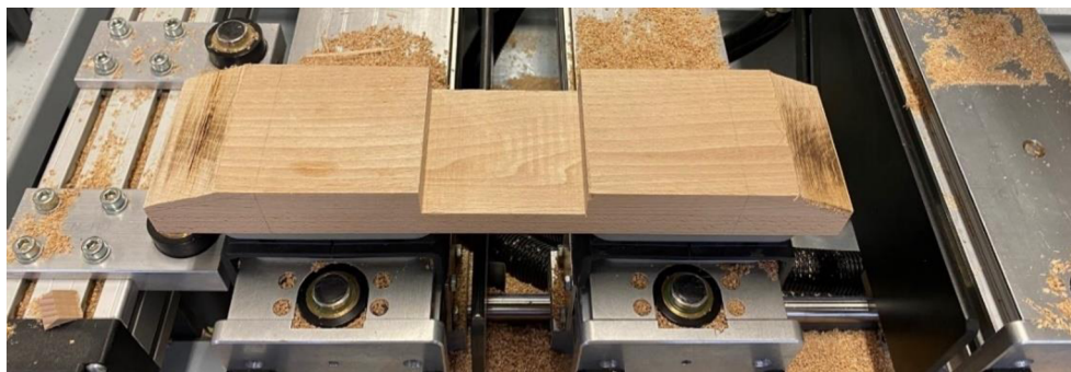
Obrázek 73 - Vyfrézování kapes pro spojení horního kříže pomocí přeplátování
