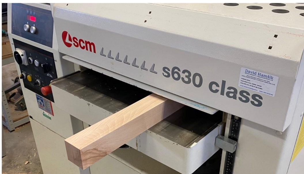
Obrázek 81 - Srovnání hranolu na horní frézce na čistý rozměr 60 x 60 mm
