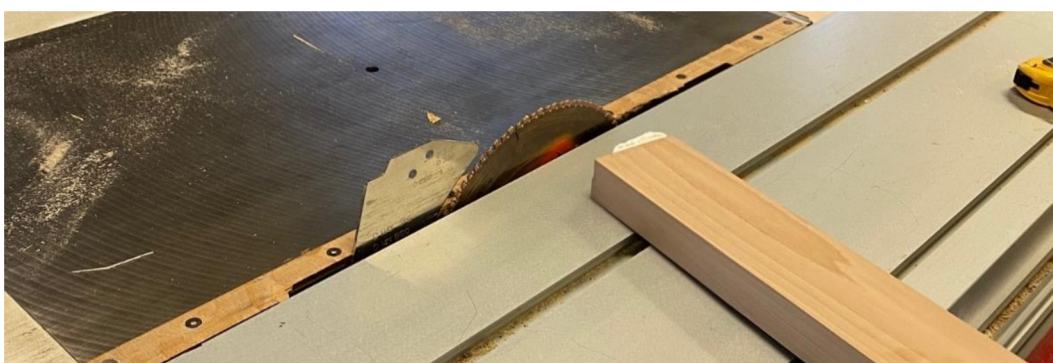
Obrázek 71 - Délkové zarovnání masivního dílce pro horní kříž
