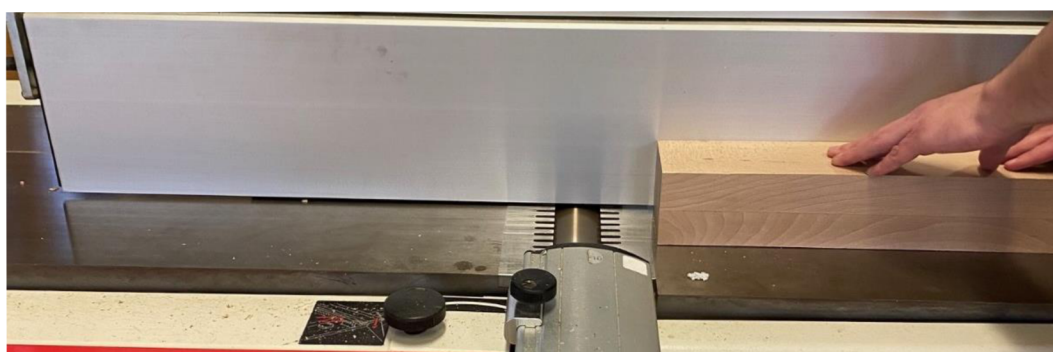
Obrázek 80 - Srovnání hranolu na spodní frézce do pravého úhlu
