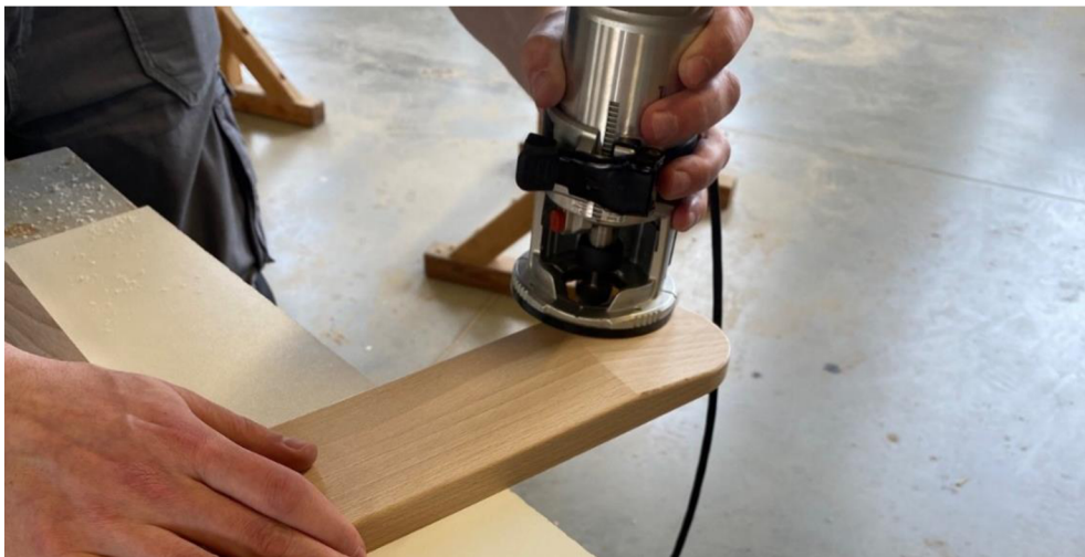
Obrázek 84 - Zaoblení hran ruční horní frézou
