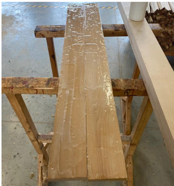
Obrázek 64 - Nanášení lepidla na masivní dílce
