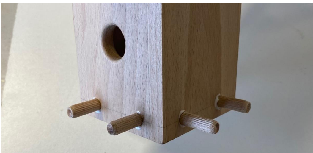
Obrázek 82 - Spojení dna s dutou nohou pomocí vlepených kolíků o rozměru 8 x 40 mm
