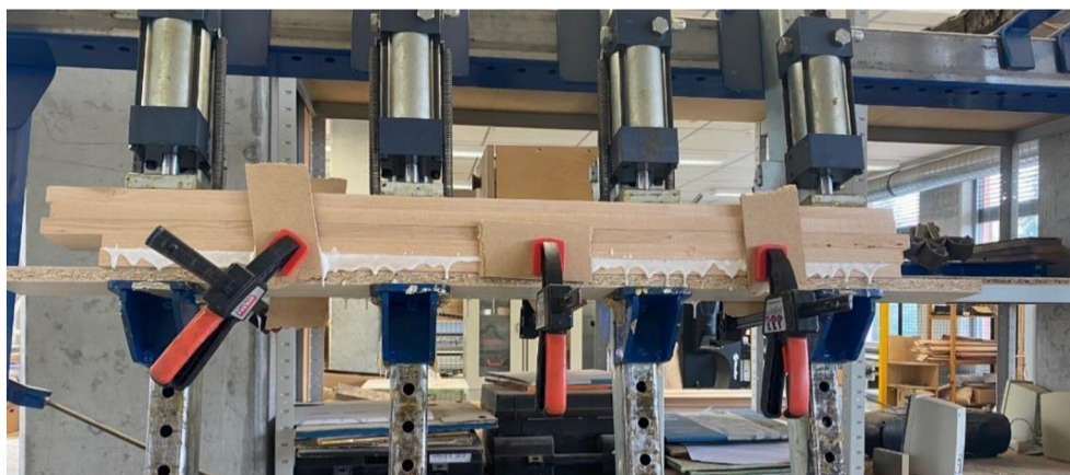
Obrázek 65 - Vytvrzení slepených dílců v lisu
