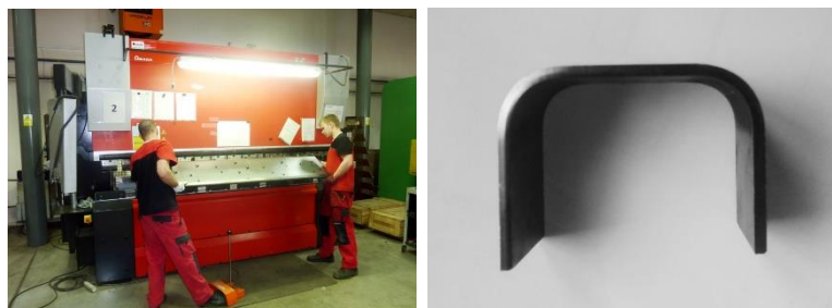
Obr. 69: (vlevo) CNC ohraňovací lis společnosti JONTECH s.r.o. Obr. 70: (vpravo) Vzorek ohýbaného plechu „patky“ stojanu
