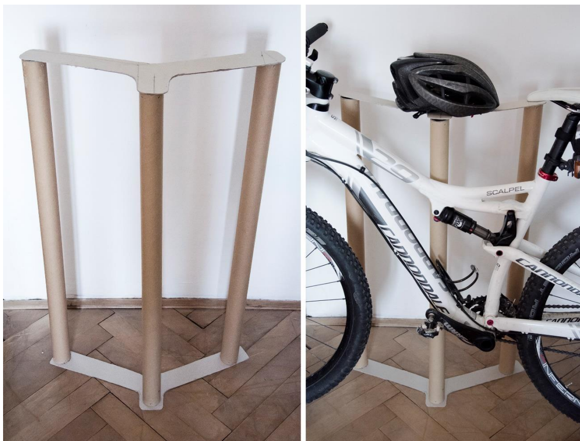
Obr. 62: Model finálního návrhu stojanu v reálném měřítku, zkouška funkčnosti odkládací plochy
