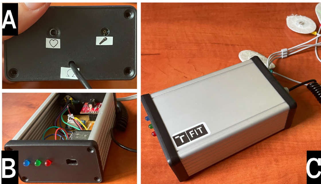
Obr. 4.1: Obrázok A zobrazuje vstupy pre jednotlivé senzory vyvedené z krabičky. Na obrázku B je vidno indikačné LED a vstup pre Micro-USB mikrokontroléru ESP32, ktoré môže slúžiť na napájanie alebo sériovú komunikáciu pri testovaní. C je ukazuje uzavretú hliníkovú krabičku slúžiacej na elimináciu vonkajšie šumu.
