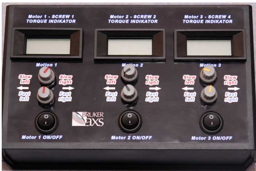
Obr. 5.11a Čelní strana řídicího modulu
