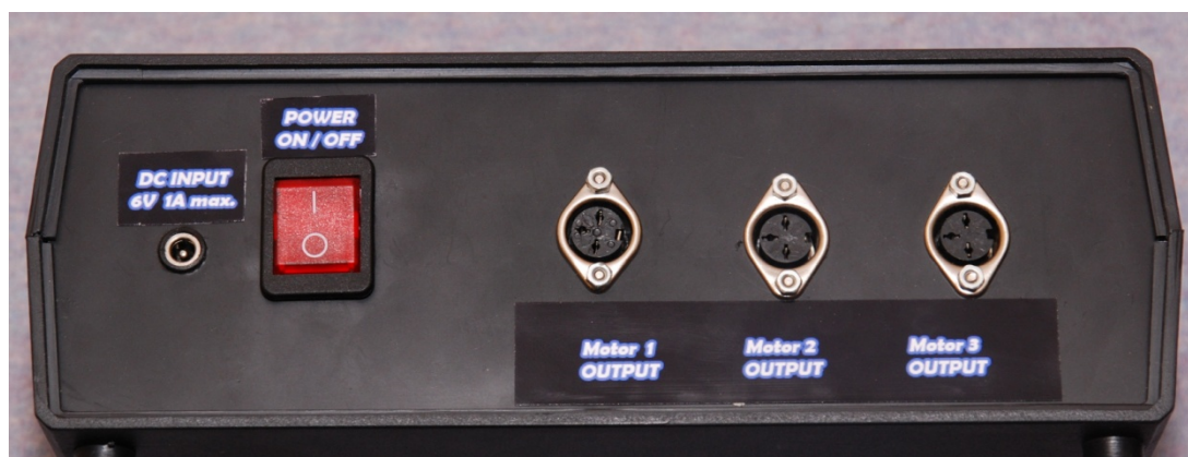
Obr. 5.11b Zadní strana řídicího modulu
