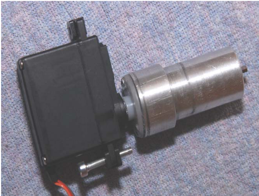
Obr. 5.16 Sestava servomotoru a spojovacího čepu
