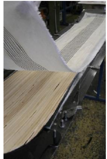
Obr. 42: Operace položení druhé vrstvy skelných vláken na dřevné jádro s lepidlem [75]
