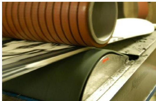
Obr. 47: Operace broušení snowboardu [75]
