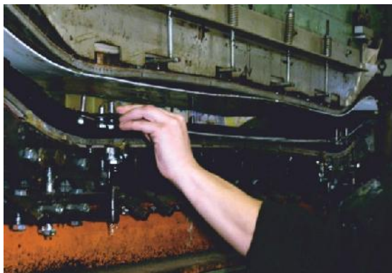
Obr. 43: Operace upevnění formy a vložení do lisu [75]
