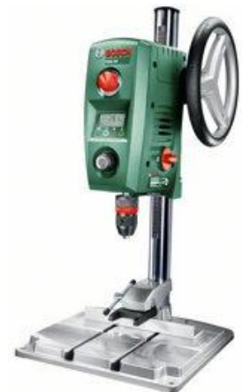
Obr. 38: Stojanová vrtačka BOSCH PBD 40 [76]
