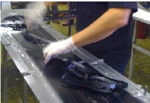
Obr. 40: Operace položení tlumící gumy po obvodu snowboardu [75]
