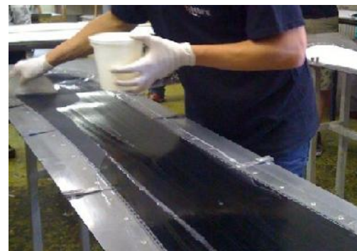
Obr. 41: Operace nanesení epoxidového lepidla na povrch skluznice [75]
