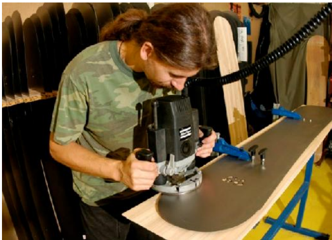
Obr. 37: Operace ořezání dřevěného jádra snowboardu pomocí frézky [75]
