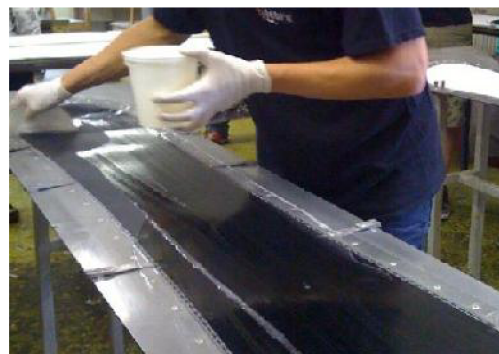
Obr. 41: Operace nanesení epoxidového lepidla na povrch skluznice [75]
