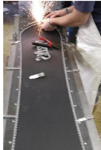
Obr. 39: Operace usazení ocelových hran po celém obvodu snowboardu [75]
