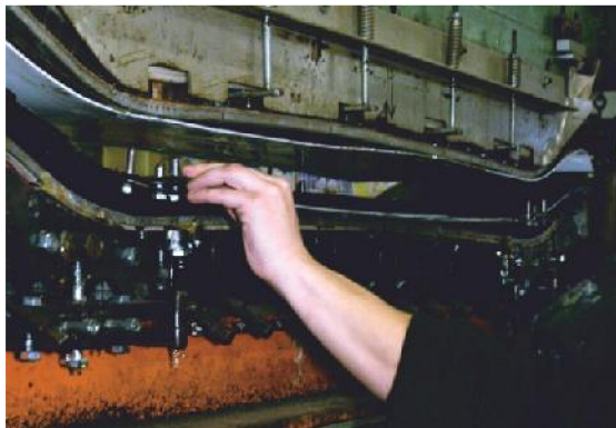
Obr. 43: Operace upevnění formy a vložení do lisu [75]
