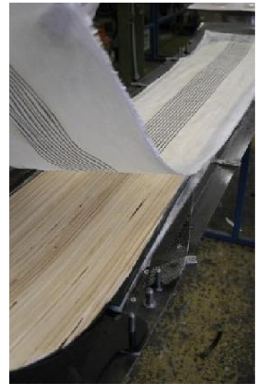
Obr. 42: Operace položení druhé vrstvy skelných vláken na dřevěné jádro s lepidlem [75]
