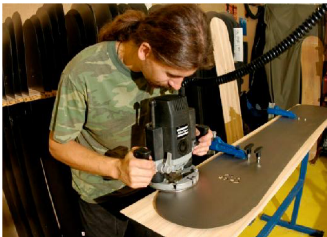
Obr. 37: Operace oříznutí dřevěného jádra snowboardu pomocí frézky [75]
