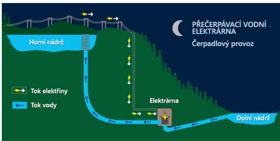
Obrázek 2 Schéma čerpadlového provozu přečerpávací vodní elektrárny
