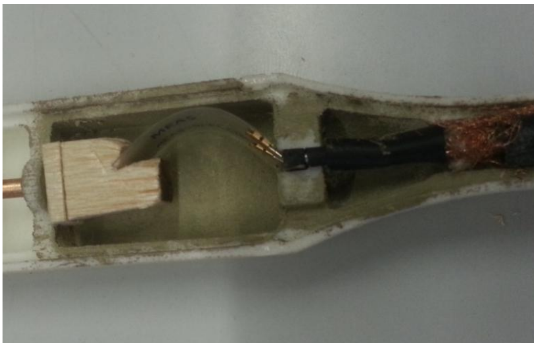
Obr. 4.2-4 Uchycení piezoelektrické folie
