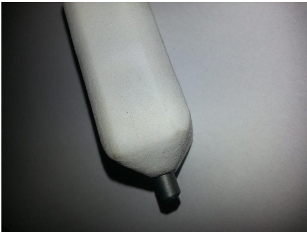
Obr. 4.3-1 Změněný tvar čela tonometru
