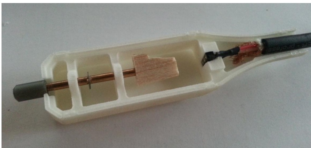
Obr. 4.2.1-5 Připravené tělo snímače pro vložení folie
