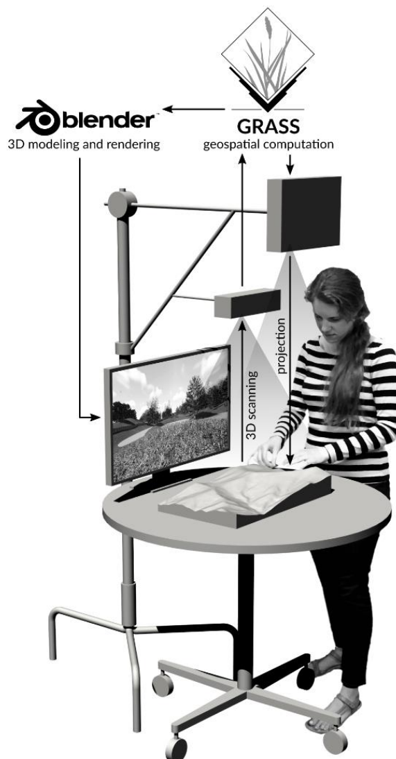
Obrázek 27: Funkční schéma systému Tangible Landscape (Petrášová et al., 2014)
