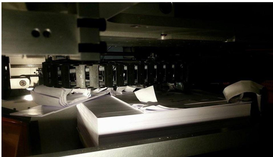
Obrázek 13: Ukázka nedokončené stavby modelu v prostředí stavebního prostoru 3D tiskárny Mcor IRIS HD
