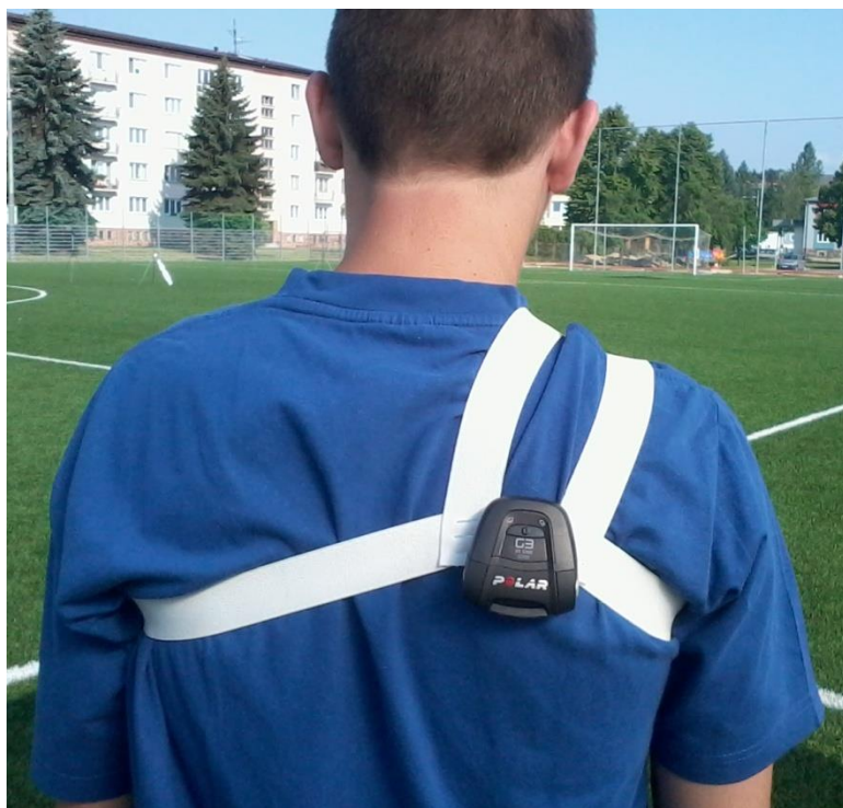
Obrázek 8. Umístění přijímače GPS Polar G3.
