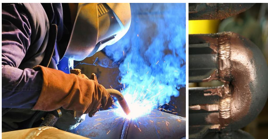
Obrázek 3: Metoda MIG/MAG v praxi (vlevo). Převzato z [11]. Svaření měděné trubky metodou MIG (vpravo). Převzato z [13].
