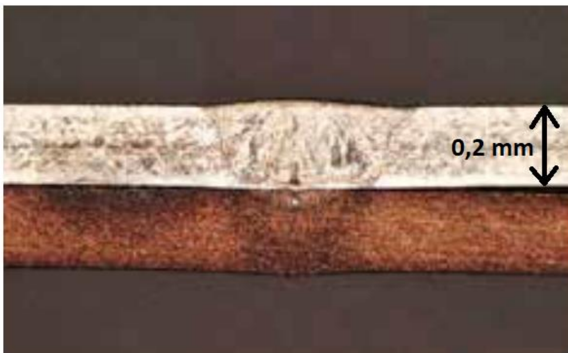
Obrázek 21: Přelátovaný svar mědi a nerezové oceli. Převzato z [39].
