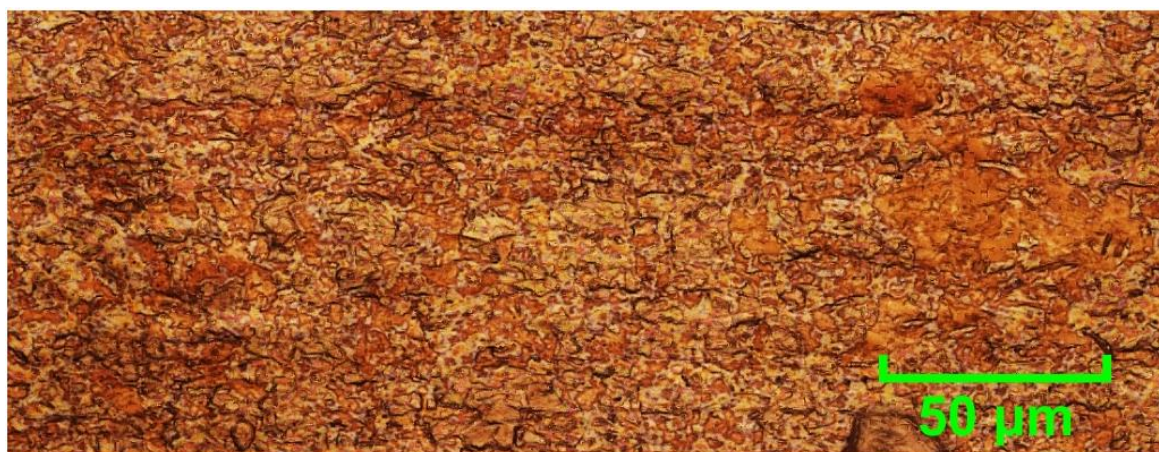
Obrázek 27: Struktura základního materiálu CuSn8. Fotografie pořízena konfokálním mikroskopem LEXT OSL5000.
