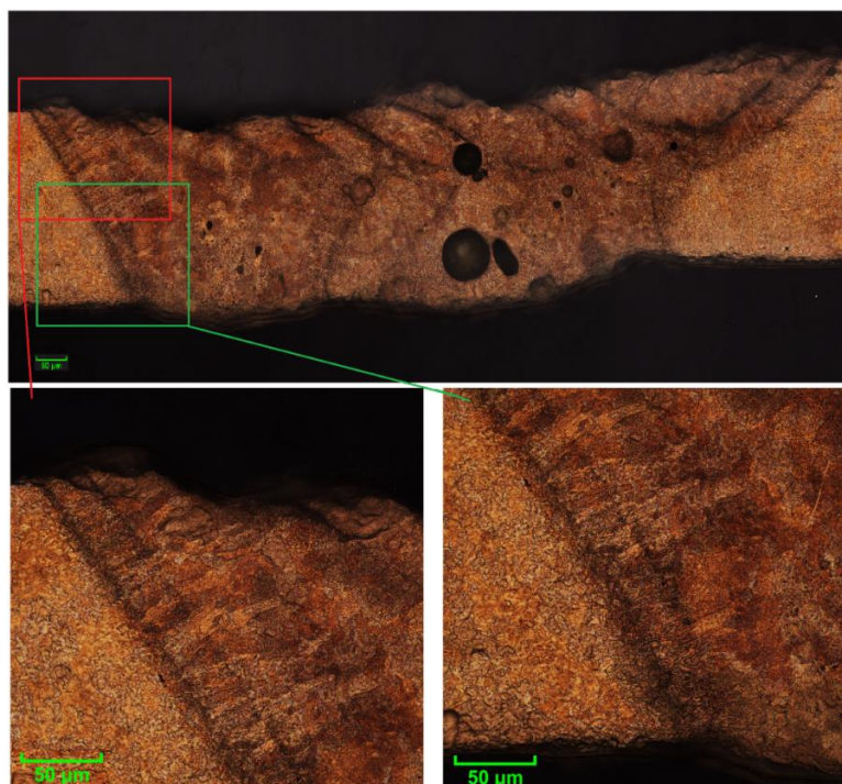
Obrázek 50: Fotografie mikrostruktury příčného řezu svarem O1.
