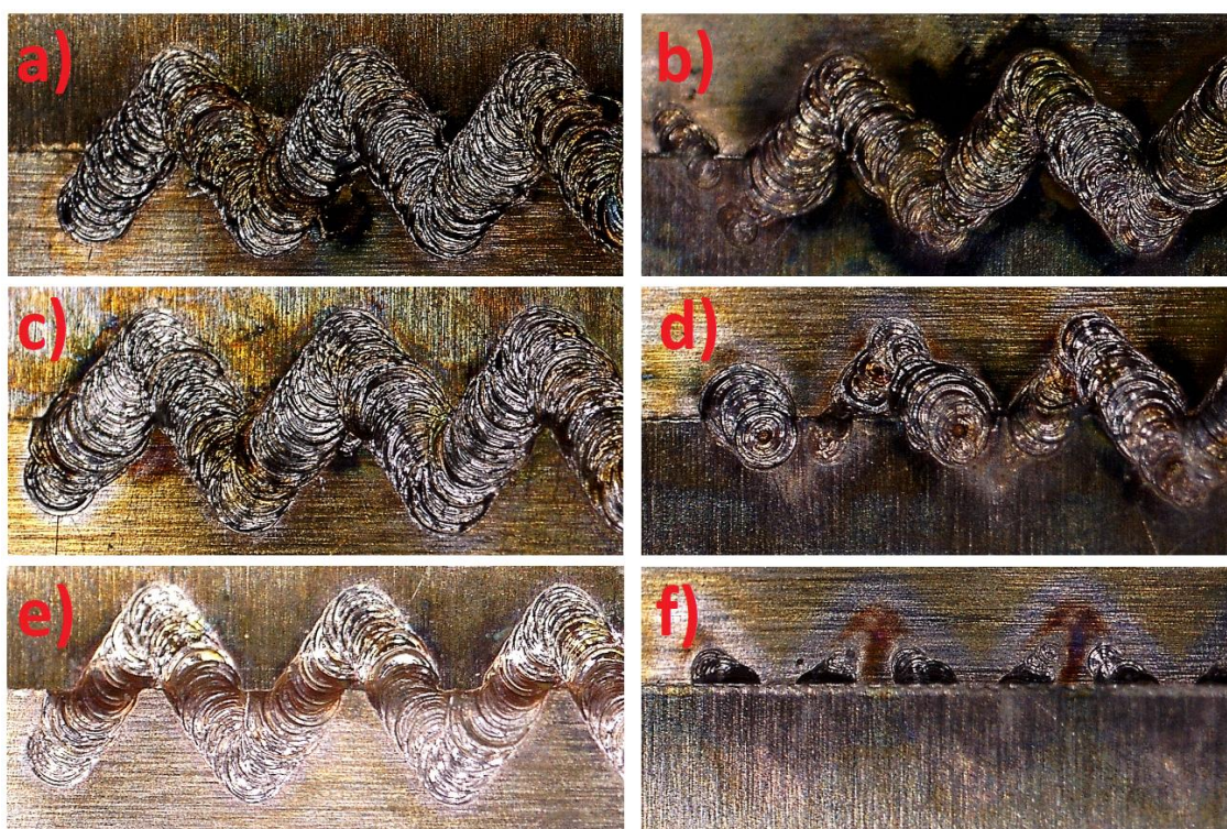
Obrázek 39: Stopa svazku na povrchu materiálu: vstupní a) a výstupní b) strana svaru P1, vstupní c) a výstupní d) strana svaru P2, vstupní e) a výstupní f) strana svaru P4.
