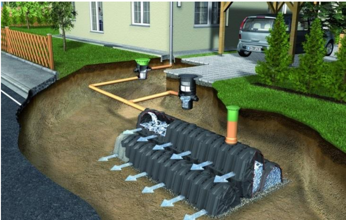
Obr. 4 – Podpovrchové vsakovací zařízení (TZB-INFO, 2017)
