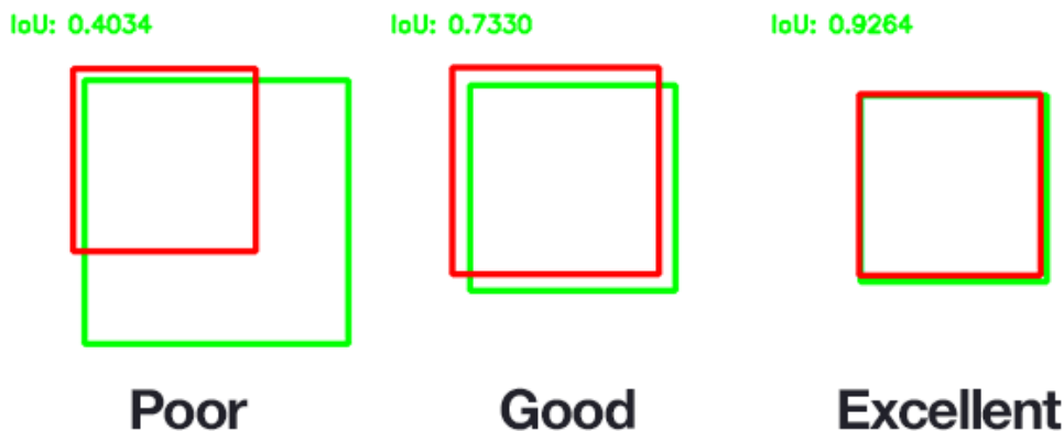
Obr. 3.4: Ukážka presnosti detekcie metódou IoU. Červený štvorec predstavuje ohraničujúci box, v ktorom sa detekovaný objekt skutočne nachádza, a zelený štvorec predstavuje box, ktorý je výstupom detekčného algoritmu. Na príklade vľavo je vidieť, že táto metóda si poradí aj s prípadom, kedy výsledné boxy síce obsahujú hľadané objekty, ale sú príliš veľké.
