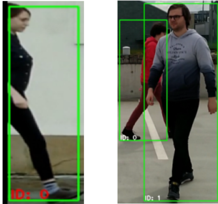
Obr. 6.6: Vľavo: osoba vstupujúca do záznamu. Polovica tela je mimo záznamu (čierny rám na kraji predstavuje hranu záznamu), čo znemožňuje kvalitnú re-identifikáciu. Vpravo: jedna z detekovaných osôb je schovaná za druhou, čo môže spôsobiť chybné rozpoznanie a v horšom prípade aj narušenie uložených príznakov.
