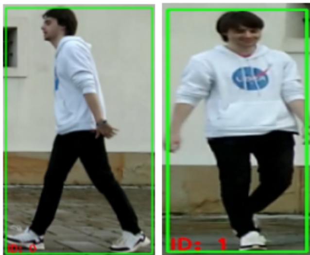
Obr. 6.5: Chybná re-identifikácia pri vstupe do záberu. Obrázok vľavo má priradené ID = 0 a obrázok vpravo nebol re-identifikovaný a teda sa mu priradilo ID = 1.
